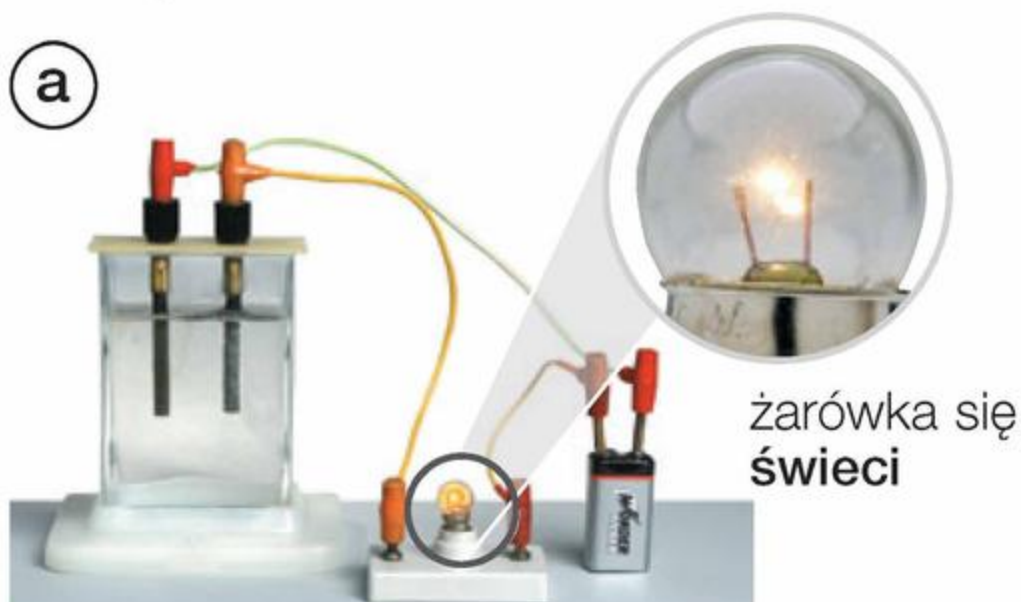
Fot. 128. Badanie zjawiska przewodzenia prądu elektrycznego przez roztwory wodne związków chemicznych: a ) elektrolity, b ) nieelektrolity.
