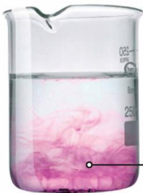
Fot. 64. Zjawisko dyfuzji – kryształy manganianu(VII) potasu (zlewka ①) i atrament (zlewka ②) wnika między cząstki wody.
