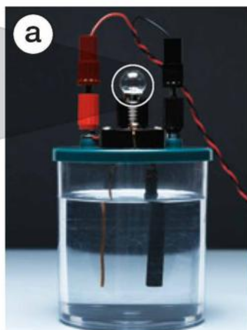
Fot. 80. Badanie zjawiska przewodzenia prądu elektrycznego przez rozpuszczony w wodzie związek kowalencyjny: cukier (a) i związek jonowy: sól kuchenną (b).
