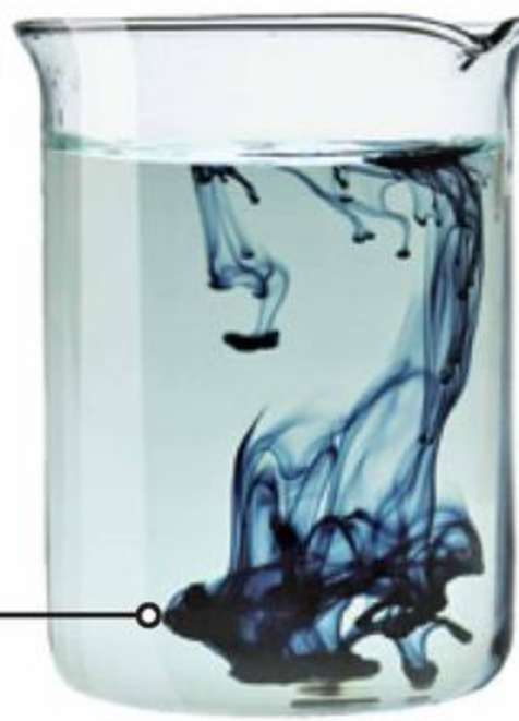
Fot. 64. Zjawisko dyfuzji – kryształy manganianu(VII) potasu (zlewka ①) i atrament (zlewka ②) wnika między cząstki wody.
