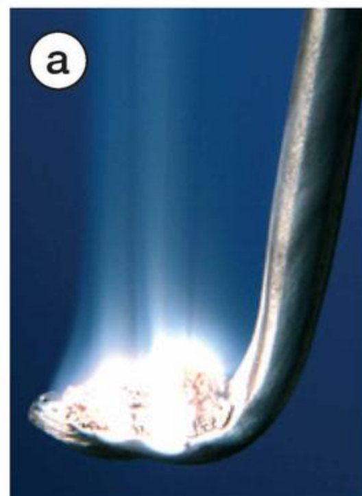
Fot. 53. W wyniku spalania (a) na łyżce powstaje biała substancja stała (b).
