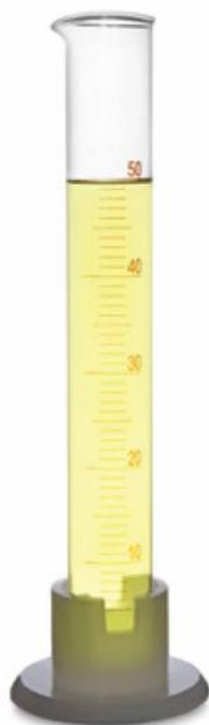
Fot. 10. Z podziałki na tym cylindrze miarowym można odczytać objętość z dokładnością do 1 \text{ cm}^3 .
