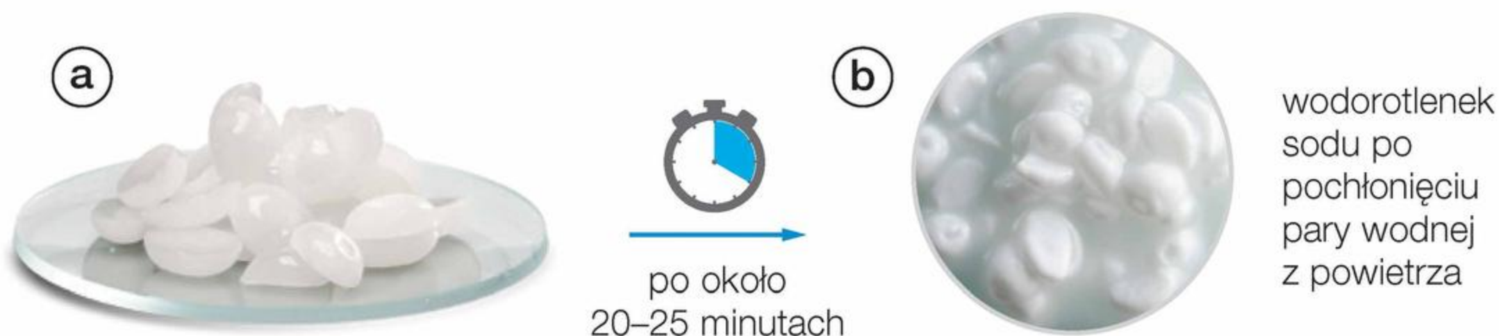
Fot. 42. Wodorotlenek sodu (a) rozpuszcza się w wodzie pochłoniętej z powietrza (b).
