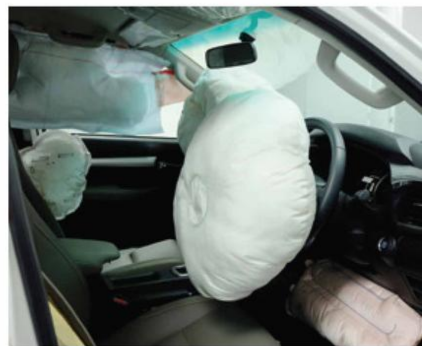
Fot. 41. Poduszka powietrzna wypełnia się gazowym azotem, uwolnionym ze związków azotu.
