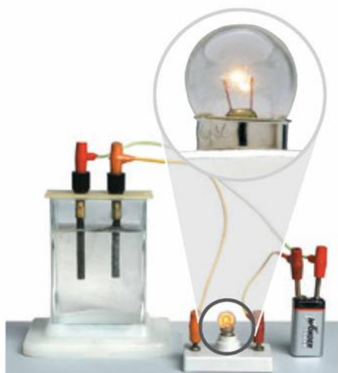
Fot. 146. Wodne roztwory zasad są elektrolitami.
