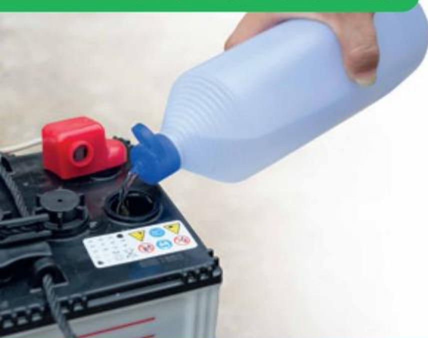
Fot. 92. Wody destylowanej używa się m.in. do uzupełniania elektrolitu w akumulatorach.
