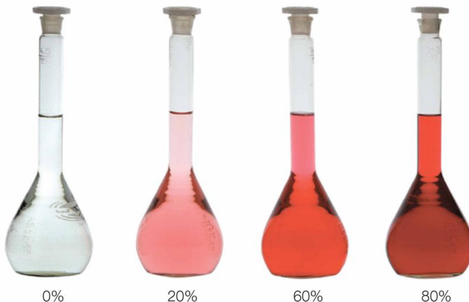
Fot. 117. Roztwory soku malinowego w wodzie. Roztwory substancji barwnych o różnych stężeniach mają różną intensywność zabarwienia.
