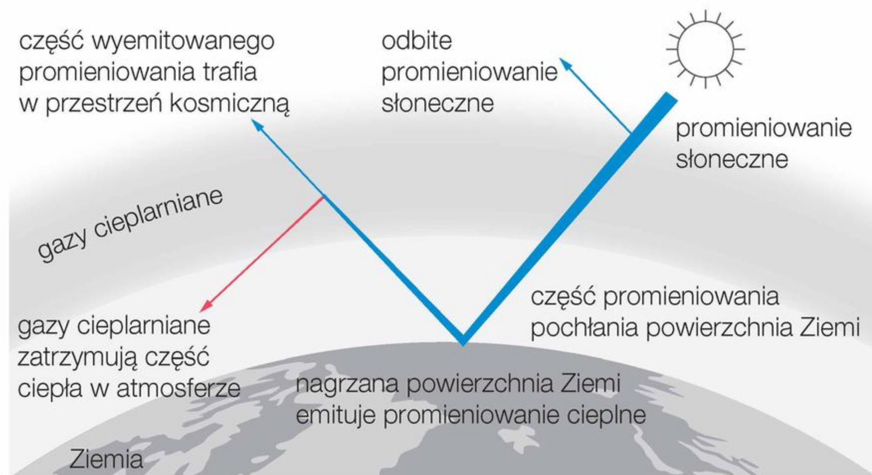
Rys. 12. Schemat powstawania efektu cieplarnianego.
