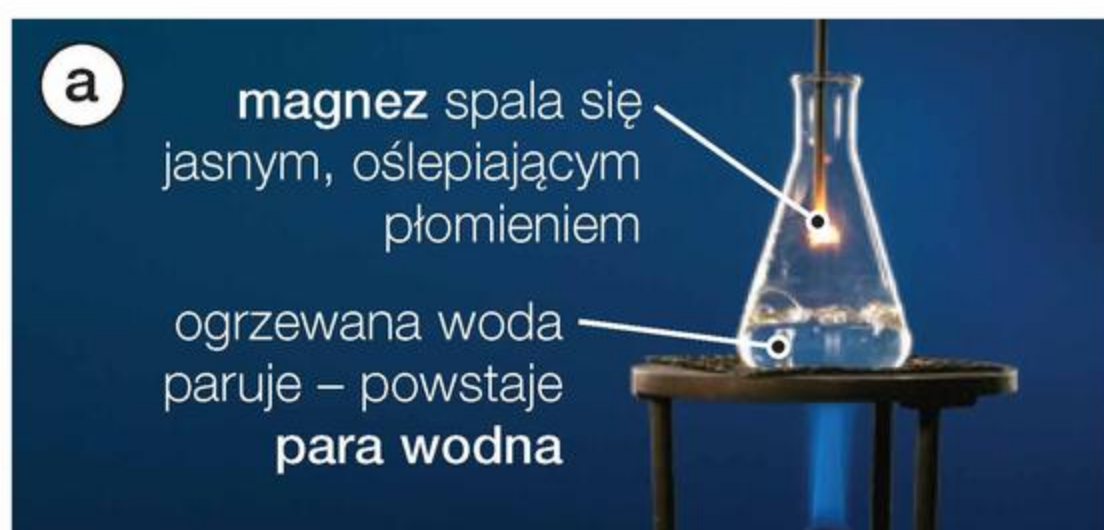
Fot. 57. Otrzymywanie wodoru w reakcji magnezu z parą wodną.
