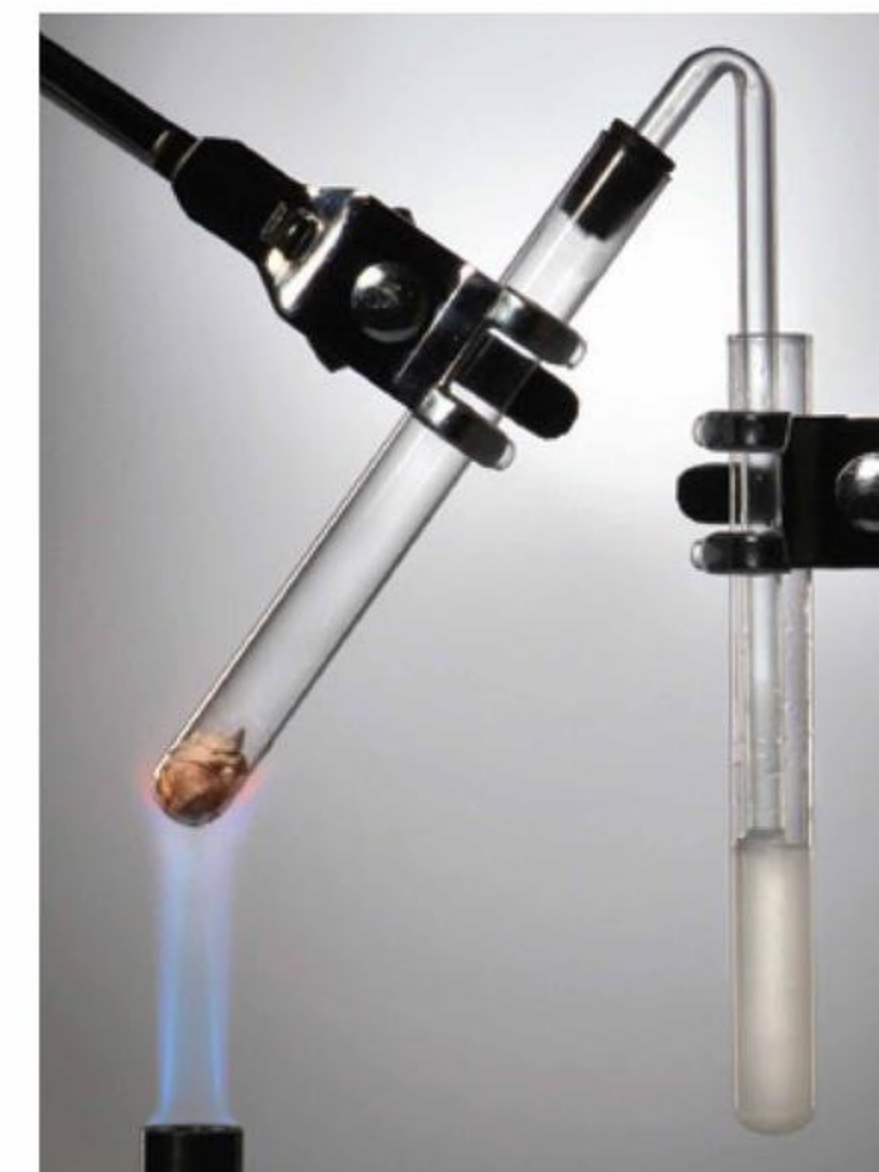
Fot. 141. Produktami prażenia wapieni są \text{CaO} i \text{CO}_2 .
