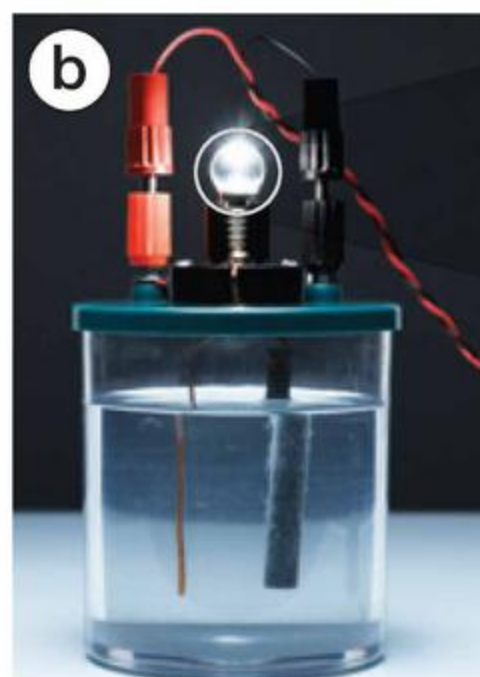
Fot. 80. Badanie zjawiska przewodzenia prądu elektrycznego przez rozpuszczony w wodzie związek kowalencyjny: cukier (a) i związek jonowy: sól kuchenną (b).
