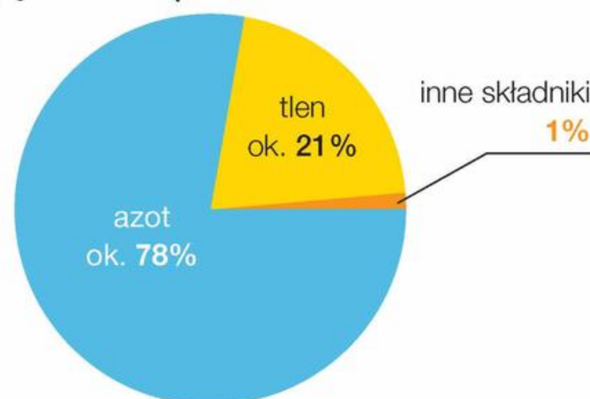
Rys. 5. Zawartość procentowa głównych składników powietrza – azot ok. 78% , tlen ok. 21% , inne składniki (m.in. argon, tlenek węgla(IV) i para wodna) 1% .
