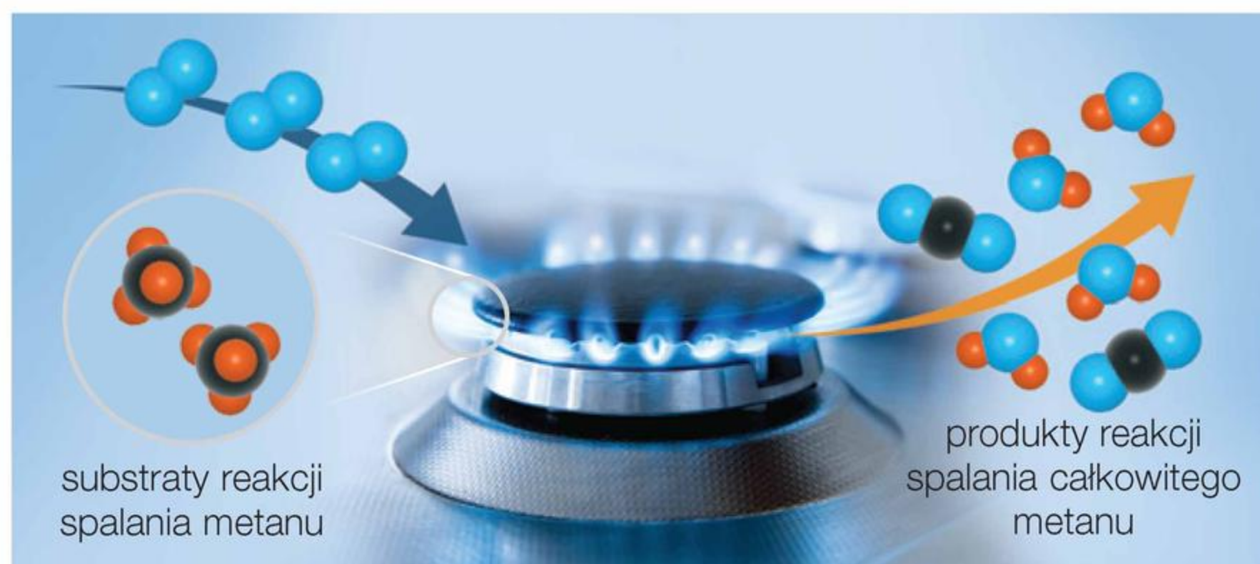
Rys. 4. Płomień palącego się gazu ziemnego nie kopci.
