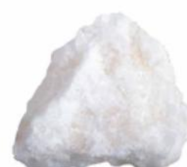
Fot. 58. Anhydryt \text{CaSO}_4 to minerał, który łatwo wchłania wodę. Dzięki temu jego objętość może się zwiększyć aż o 60 %.
