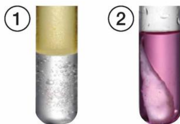
Fot. 133. Identyfikacja tłuszczów za pomocą rozcieńczonego roztworu manganianu(VII) potasu: olej roślinny ①, smalec ②.
