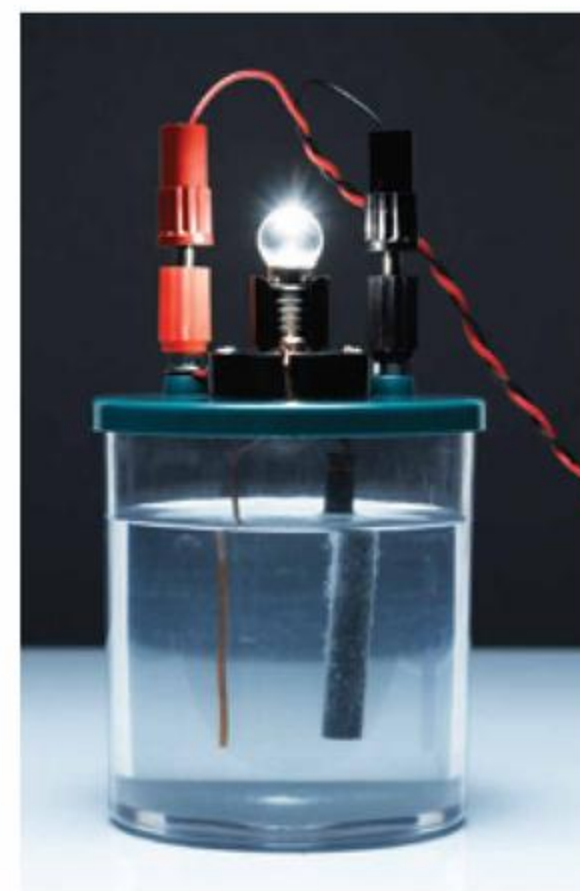
Fot. 36. Wodne roztwory soli i sole stopione przewodzą prąd elektryczny.
