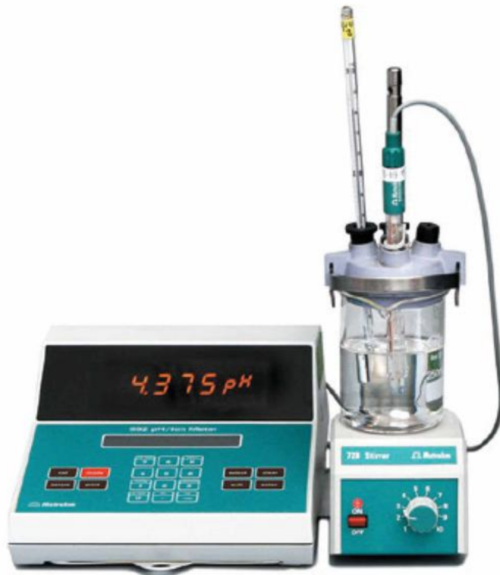
Fot. 29. Pehametr jest urządzeniem, które najdokładniej wyznacza wartość pH roztworu.
