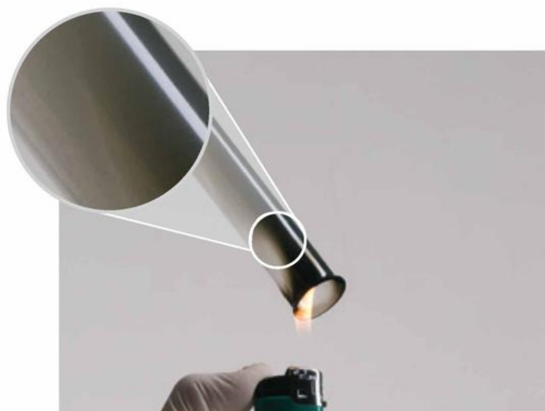
Fot. 75. Spalanie butanu.
