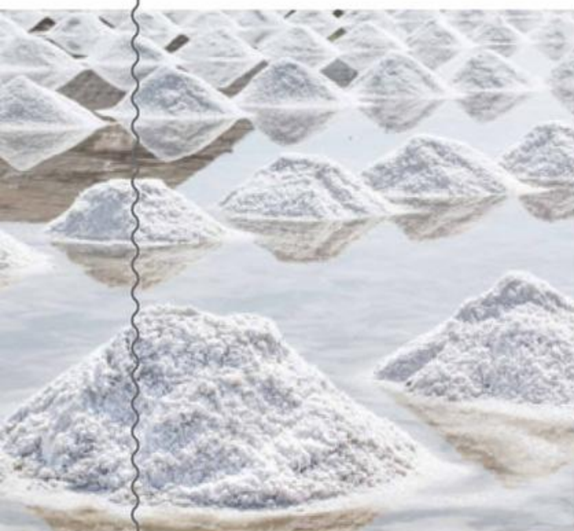
Fot. 52. Odparowanie wody to najprostsza i najtańsza metoda pozyskiwania NaCl.
