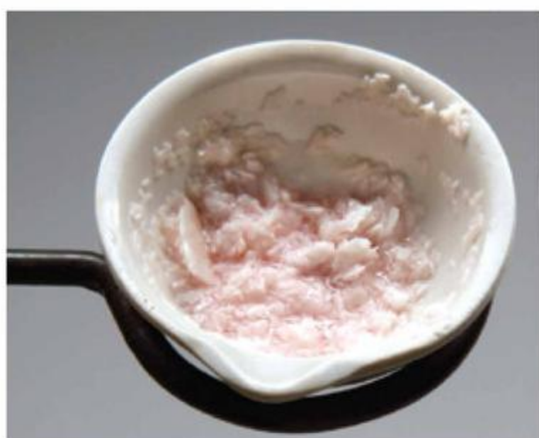
Fot. 120. Produktem reakcji kwasu stearynowego z wodorotlenkiem sodu jest mydło sodowe.
