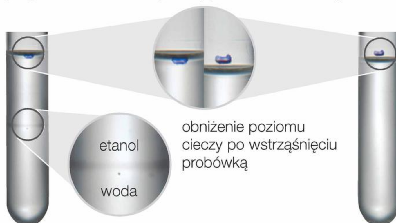
Fot. 94. Mieszanie etanolu z wodą.
