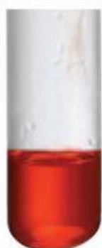
Fot. 110. Czerwona barwa oranżu metylowego świadczy o odczynie kwasowym roztworu kwasu octowego.
