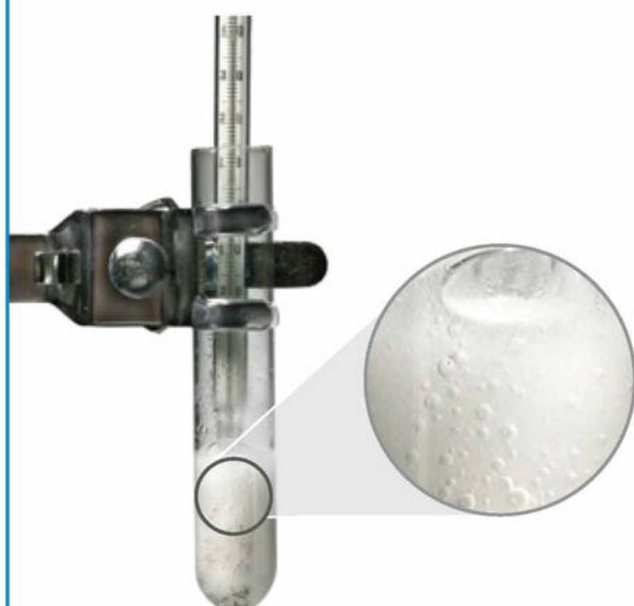
Fot. 112. Reakcja kwasu octowego z magnezem.
