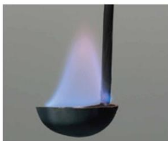
Fot. 111. Spalanie kwasu octowego.
