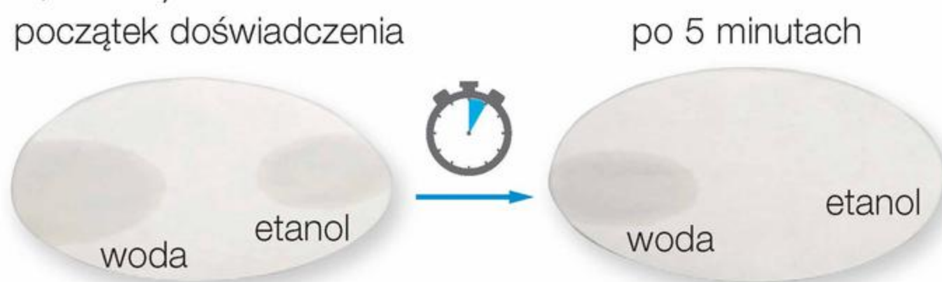
Fot. 95. Porównanie lotności etanolu i wody.
