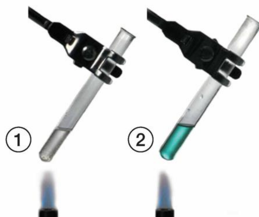
Fot. 46. Reakcje z kwasem chlorowodorowym HCl: ① tlenku magnezu MgO; ② tlenku miedzi(II) CuO.
