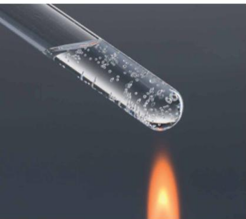
Fot. 20. Pęcherzyki gazu to tlenek węgla(IV), który uwalnia się z gazowanej wody mineralnej pod wpływem delikatnego ogrzewania.
