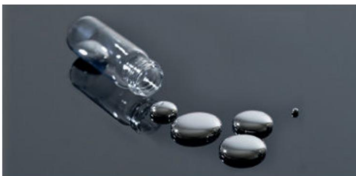
Rtęć w temperaturze pokojowej (20°C) jest cieczą, ale jeśli temperaturę obniży się do poniżej -39°C, stanie się ciałem stałym. Termometry rtęciowe są stosowane np. w laboratoriach.
