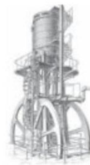
Dmuchawa napędzana silnikiem parowym z XIX w.
