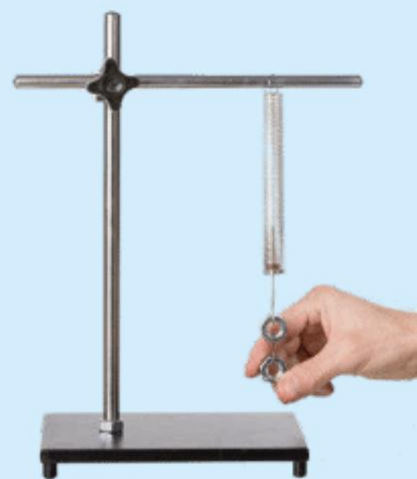
Częstotliwość drgań zależała od masy zawieszonych ciężarków.
