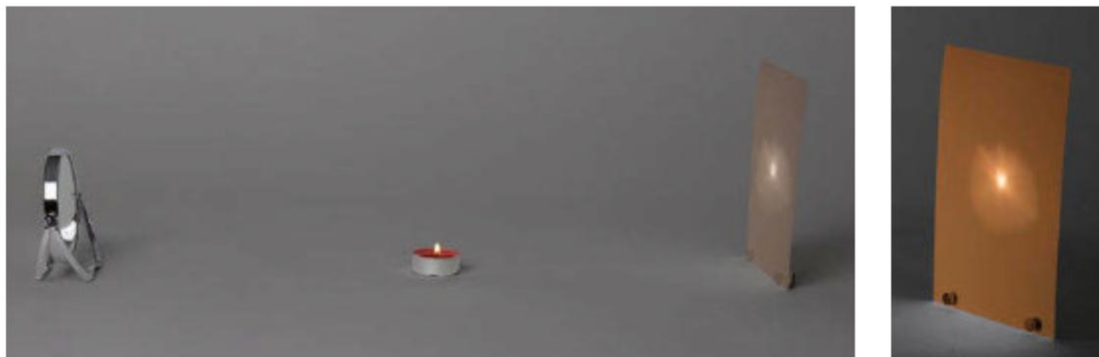
Obraz płomienia uzyskany na ekranie po jego odbiciu od zwierciadła wklęsłego.
