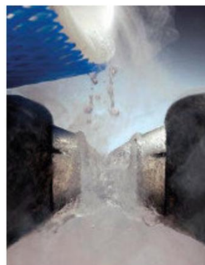
Ciekły tlen jest przyciągany przez bardzo silny elektromagnes (na zdjęciu widać fragment rdzenia elektromagnesu w kształcie rozciętej od góry litery O). Świadczy to o paramagnetycznych właściwościach tej substancji.
