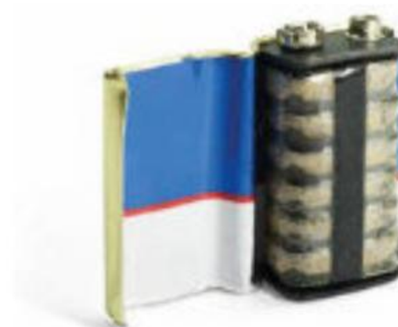
Bateria 9 V jest zbudowana z sześciu połączonych ogniw.
