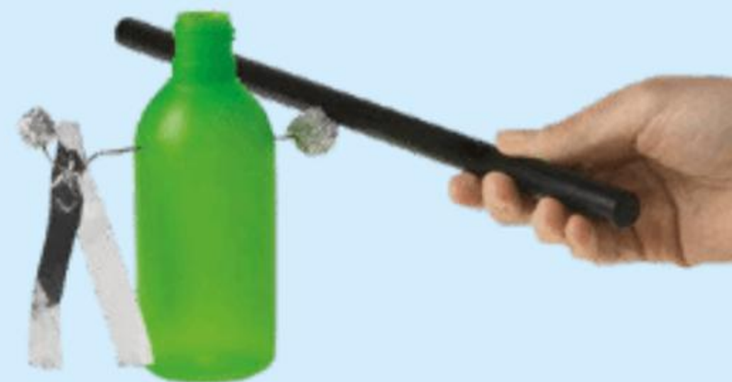
Zbudowany przyrząd to prosty elektroskop – urządzenie umożliwiające badanie stopnia naelektryzowania ciała.
