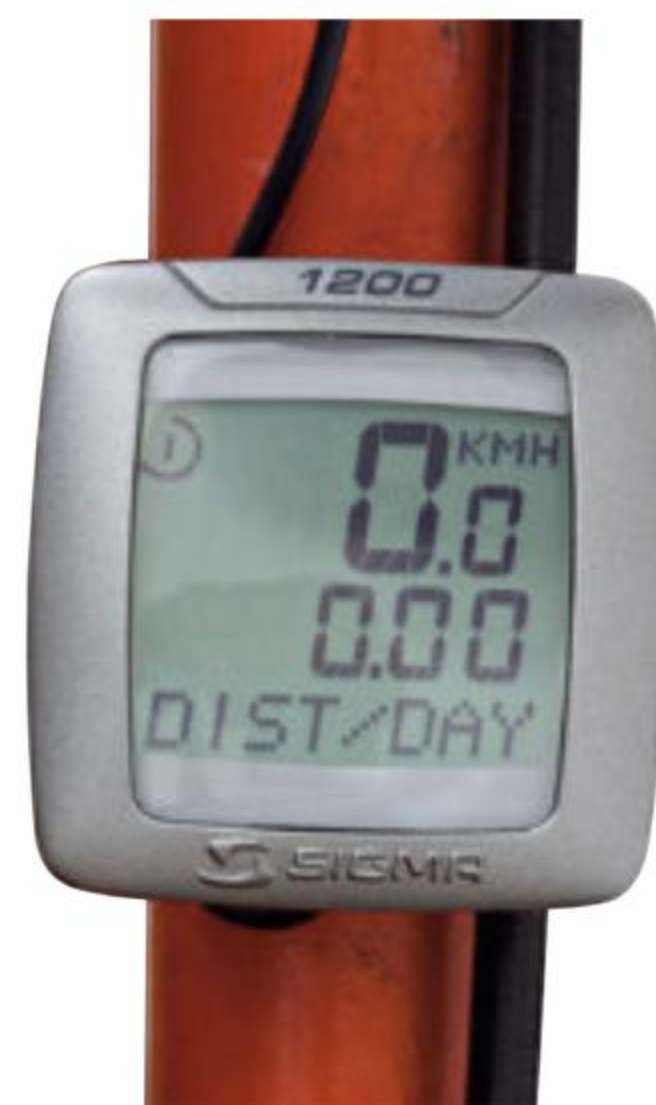
Prędkościomierz rowerowy informuje także o przebytej drodze i czasie jazdy.
