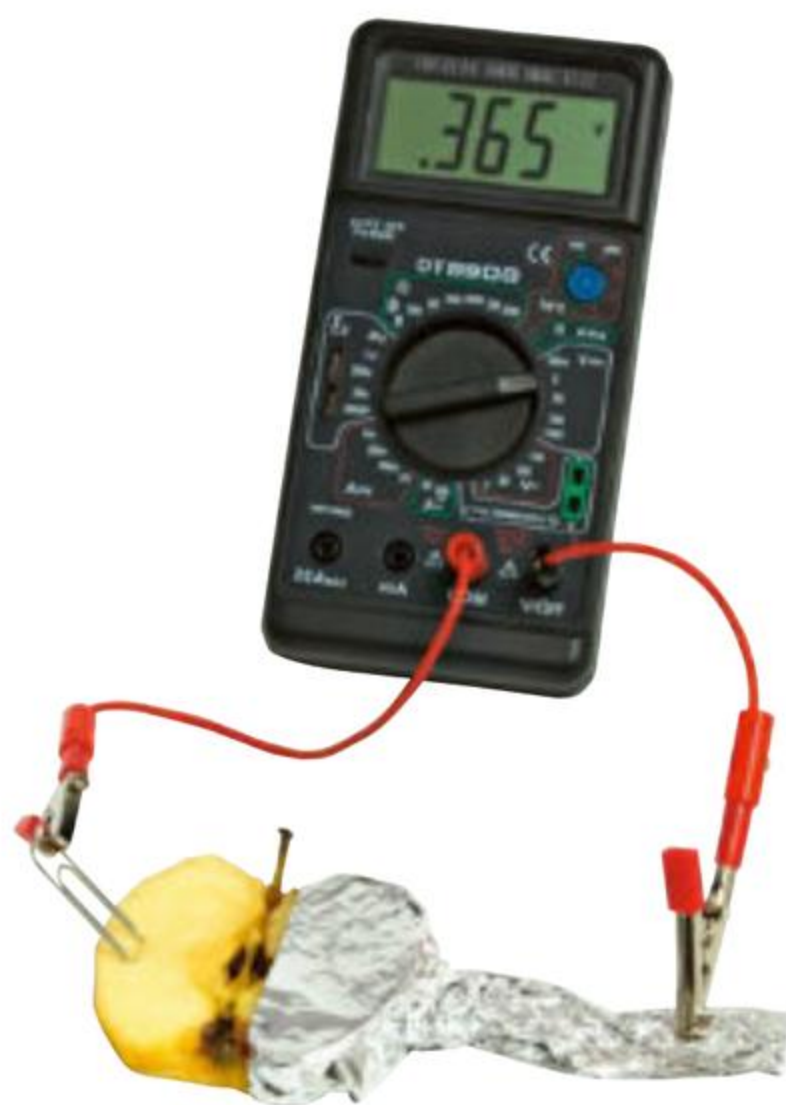
Pomiar napięcia elektrycznego w obwodzie z owocowym ogniwem.
