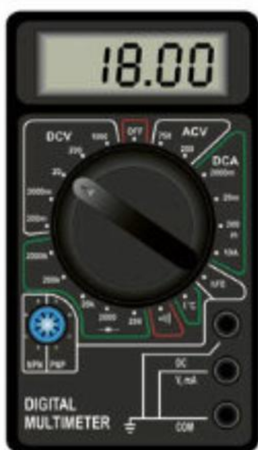
Cyfrowy miernik uniwersalny. Skrót DC oznacza prąd stały (direct current), więc DCV to wolty prądu stałego.
