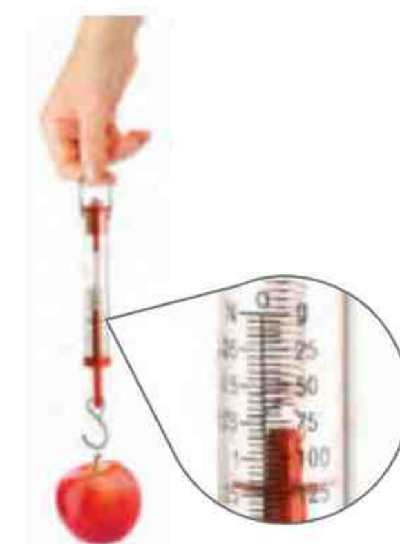
Siłomierz wskazuje nie tylko siłę, z jaką Ziemia oddziałuje na jabłko (ok. 1,25 N), ale także przybliżoną masę jabłka (ok. 125 g).
