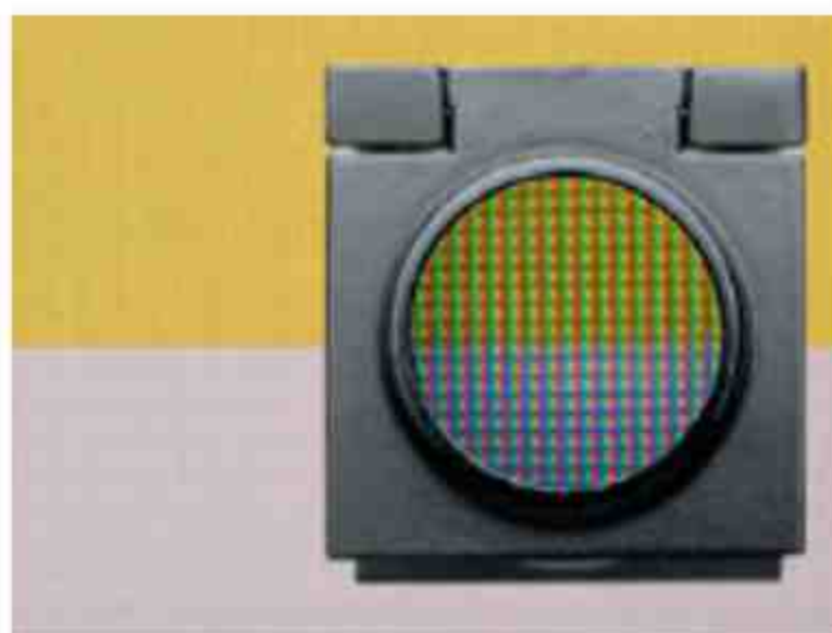
Widoczna na ekranie barwa żółta to efekt połączenia światła zielonego i czerwonego.
