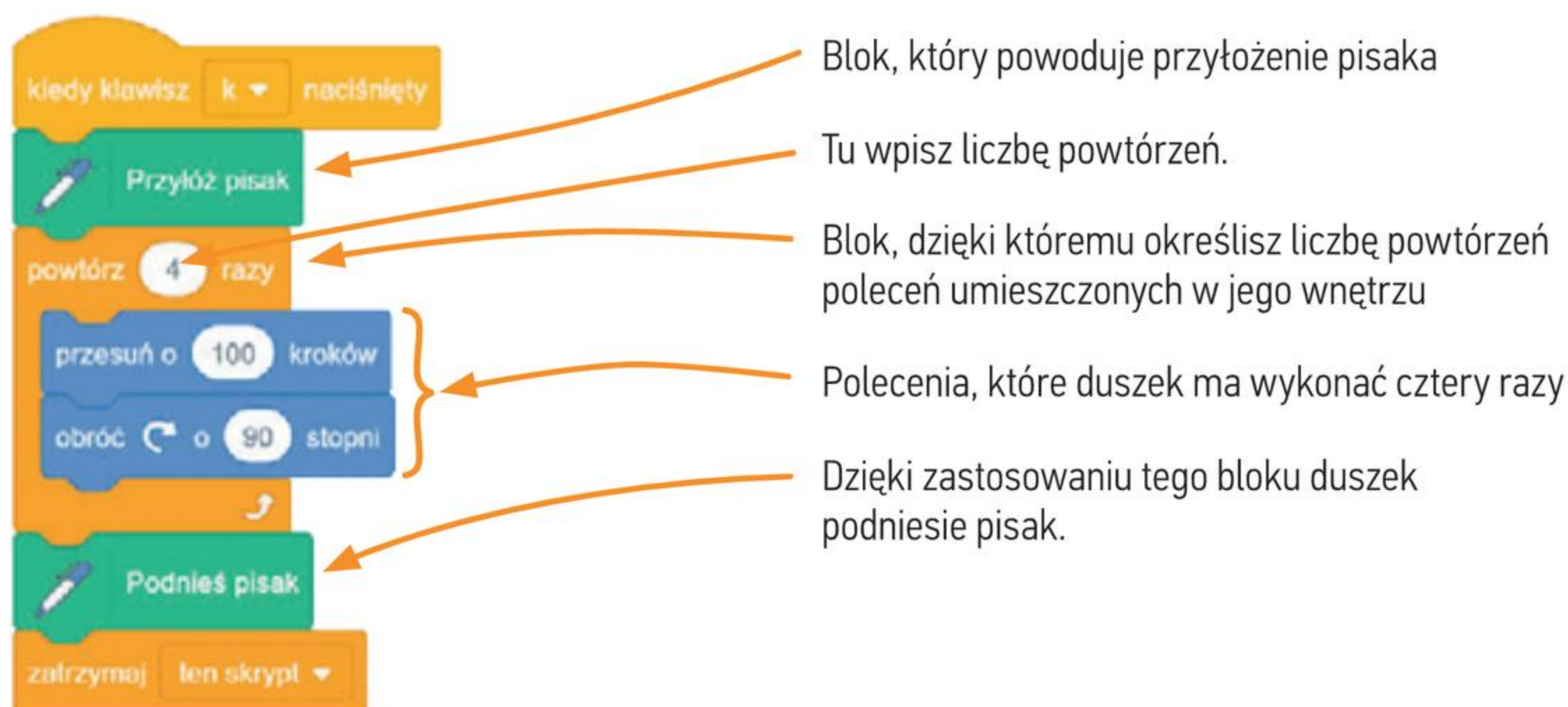
Rys. 3. Skrypt określający rysowanie kwadratu o boku 100 kroków
