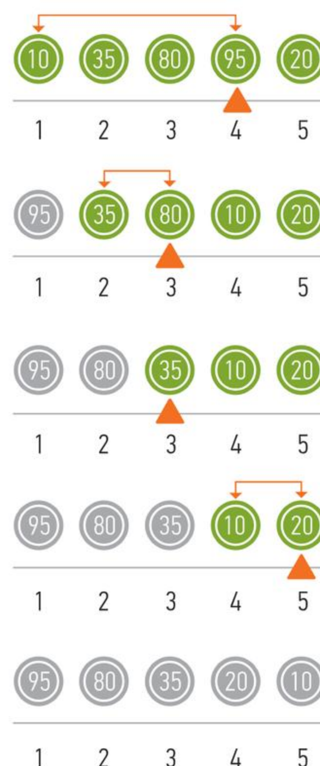
Rys. 1. Przykład porządkowania liczb metodą przez wybieranie – od największej do najmniejszej
