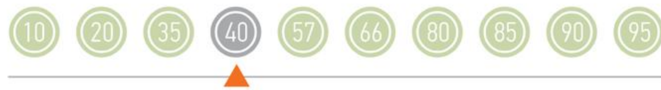
Rys. 6. Przykład wyszukiwania liczby w zbiorze uporządkowanym metodą połowienia
