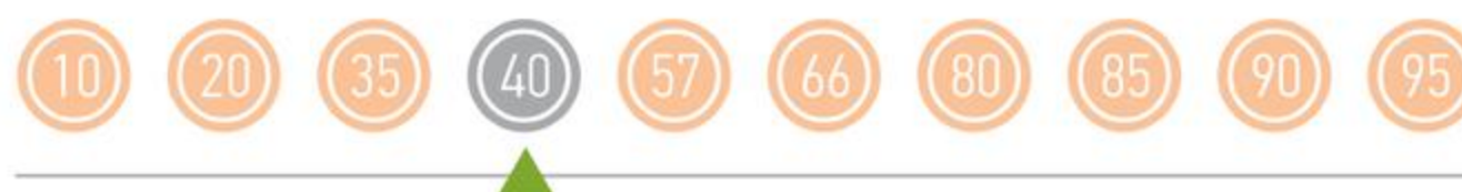
Rys. 6. Przykład wyszukiwania liczby w zbiorze uporządkowanym metodą połowienia
