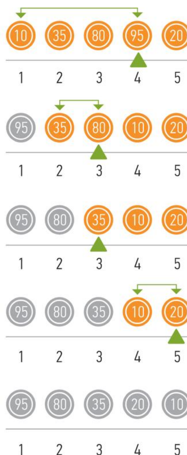
Rys. 1. Przykład porządkowania liczb metodą przez wybieranie – od największej do najmniejszej
