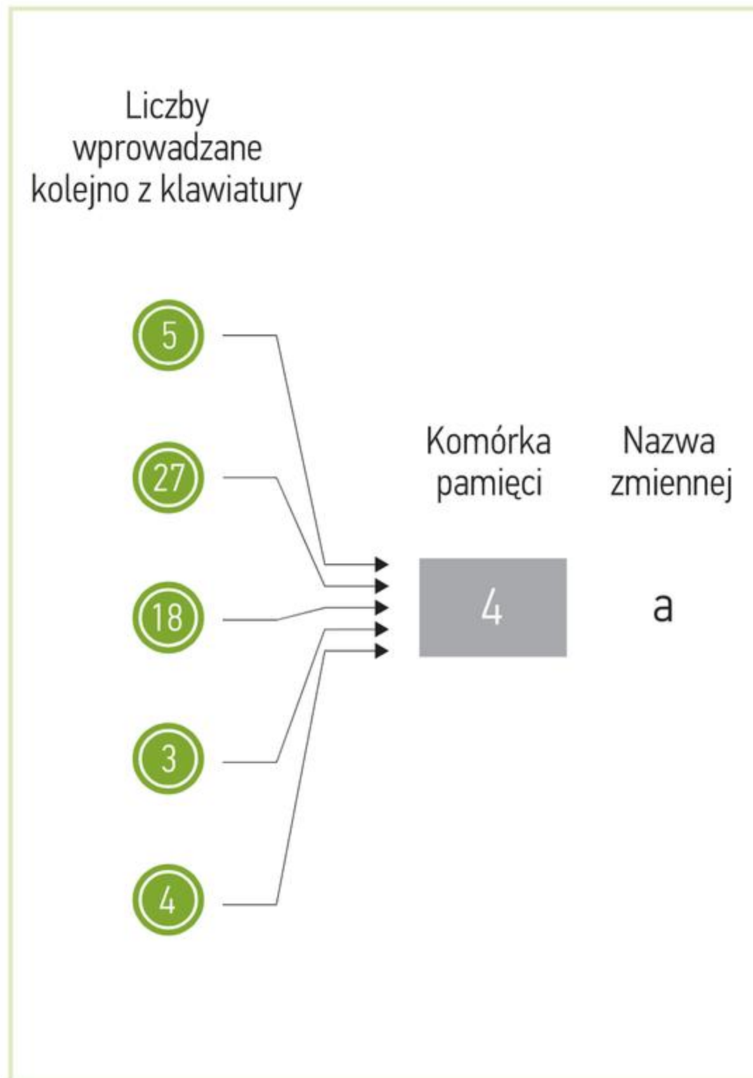
Rys. 13a. Zapisywanie w pamięci komputera wartości danych wprowadzanych z klawiatury z użyciem jednej zmiennej
