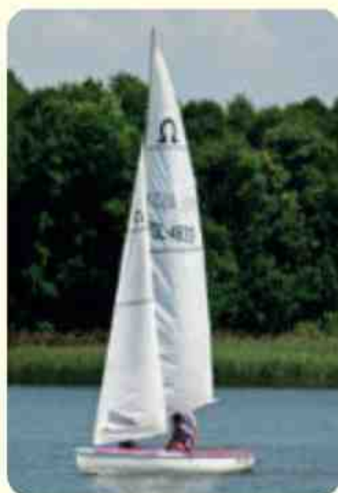
Omega załoga: do 6 osób dł. 6,20 m, szer. 1,80 m masa: 250 kg ożaglowanie: grot 9,00 \text{ m}^2 , fok 6,00 \text{ m}^2
