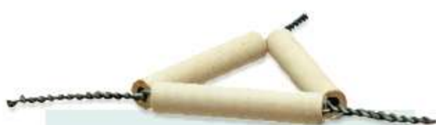
Trójkąt do umieszczania w nim tygli podczas prażenia
