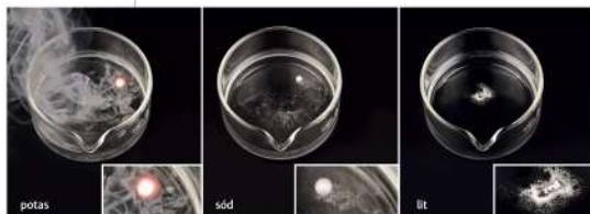
▲ Reakcja potasu z wodą zachodzi gwałtowniej niż reakcja sodu. Najwolniej przebiega reakcja litu z wodą.
