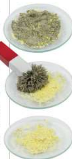
▲ Rozdzielanie mieszaniny siarki i żelaza za pomocą magnesu
