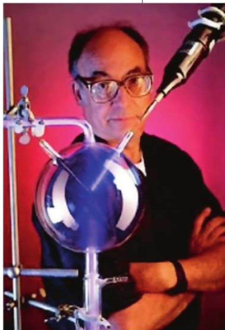
▲ Aparatura Stanleya Millera do symulacji początków życia
