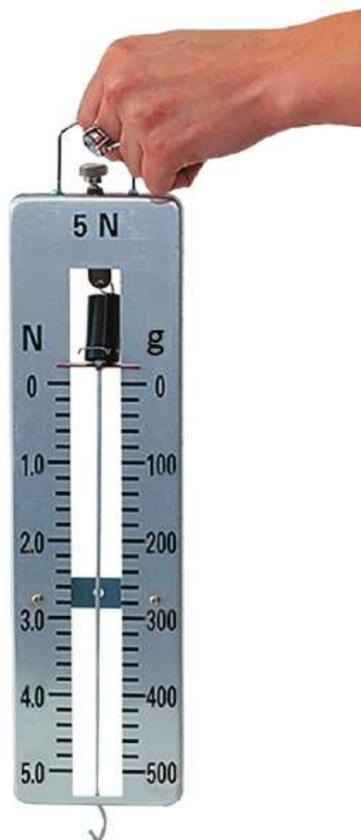
Ryc. 4.4. Siłomierz wyskalowany w jednostkach siły (N) i jednostkach masy (g)
