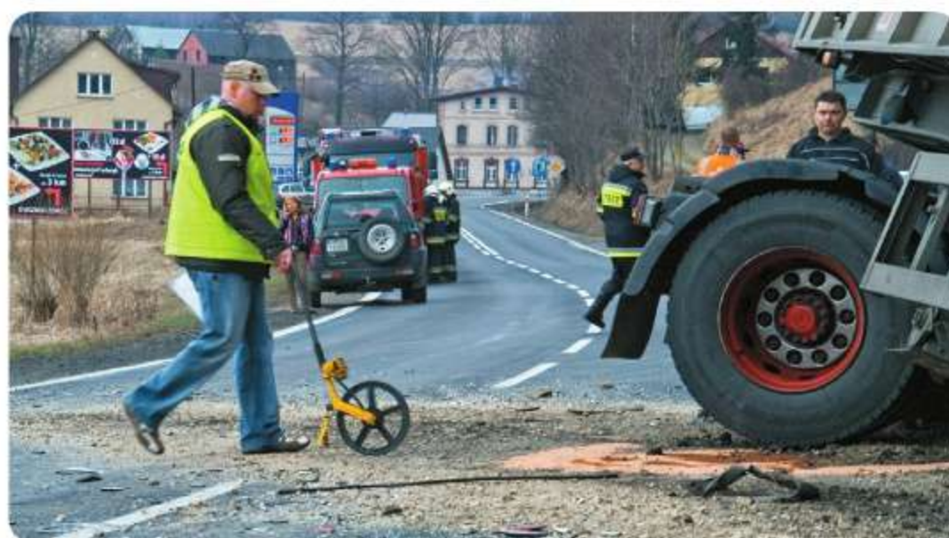
Ryc. 14.5. Pomiar drogi hamowania pojazdu uczestniczącego w kolizji
