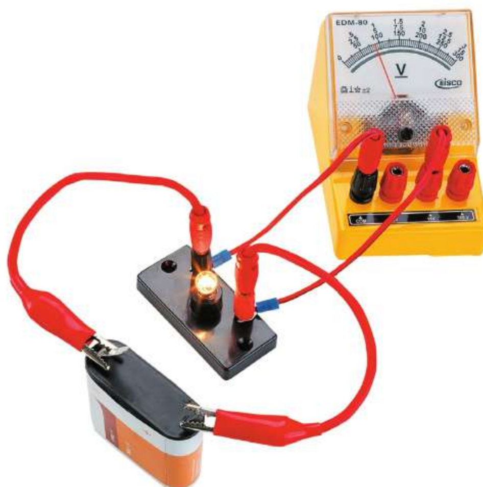
Ryc. 14.6. Woltomierz podłączony do źródła napięcia (a) i woltomierz podłączony do odbiornika energii elektrycznej (b)
