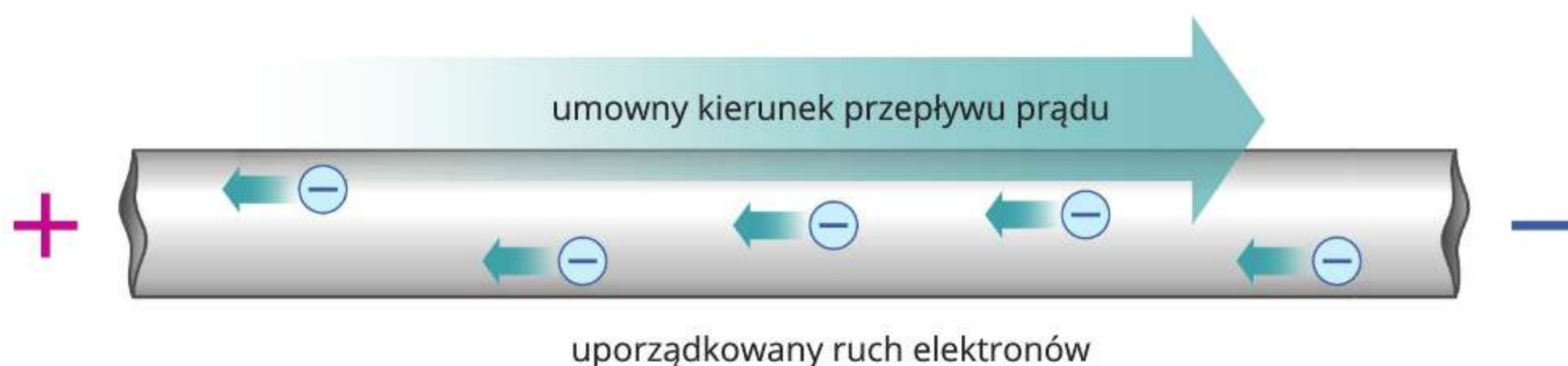
Ryc. 15.2. Kierunek ruchu elektronów i umowny kierunek przepływu prądu elektrycznego
