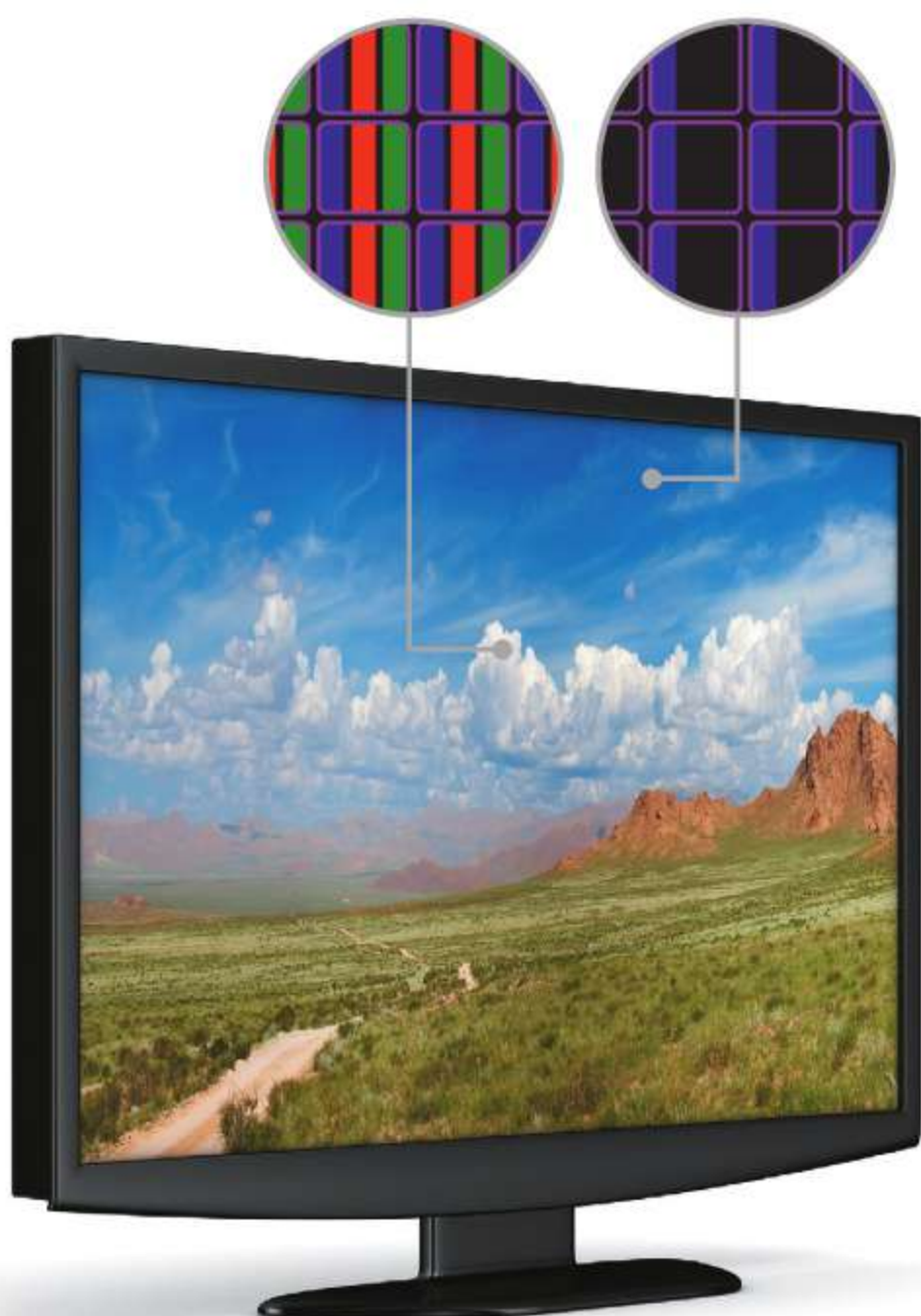
Ryc. 25.3. Różne kolory na ekranie jako efekt świecenia pikseli o różnych barwach
