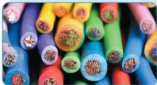
Miedź bardzo dobrze przewodzi prąd, dlatego stosuje się ją m.in. w instalacjach elektrycznych
