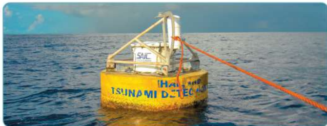
Detektor (urządzenie do wykrywania) tsunami na Morzu Andamańskim
