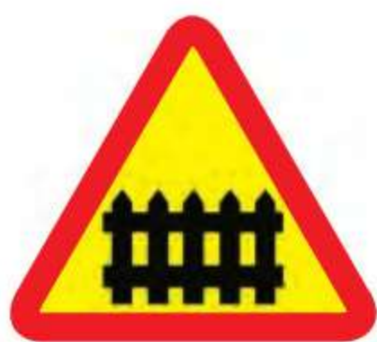
Przejazd kolejowy z zaporami
