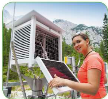
Klatka meteorologiczna zawiera przyrządy służące do pomiarów składników pogody.
