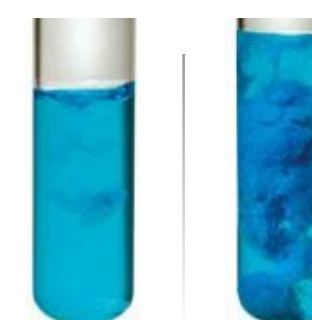
Fot. 87. Strącanie się osadu wodorotlenku miedzi(II) \text{Cu}(\text{OH})_2 .
