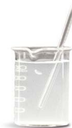
Fot. 69. Widoczne zmętnienie nasyconego roztworu wodorotlenku wapnia powstaje pod wpływem wprowadzanego tlenku węgla(IV).
