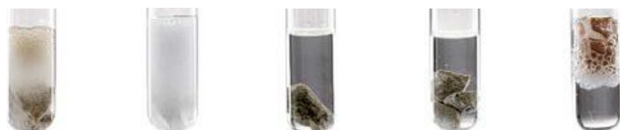
Fot. 68. Wykrywanie węglanu wapnia – pęcherzyki gazu świadczą o zajściu reakcji chemicznej.
