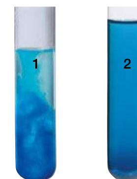
Fot. 63. Po dodaniu kwasu chlorowodorowego do osadu wodorotlenku miedzi(II) (próbówka 1.) powstaje klarowny niebieski roztwór (próbówka 2.).
