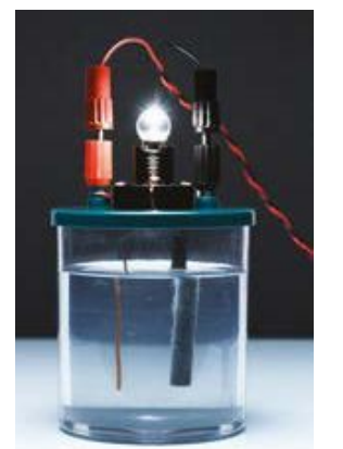
Fot. 45. Świecąca żarówka świadczy o tym, że zasady przewodzą prąd elektryczny.
