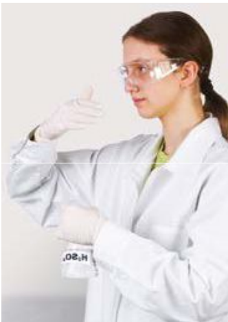
Fot. 7. Zapach substancji zawsze należy badać ruchem wachlującym dłoni z zachowaniem zasad bezpieczeństwa.
