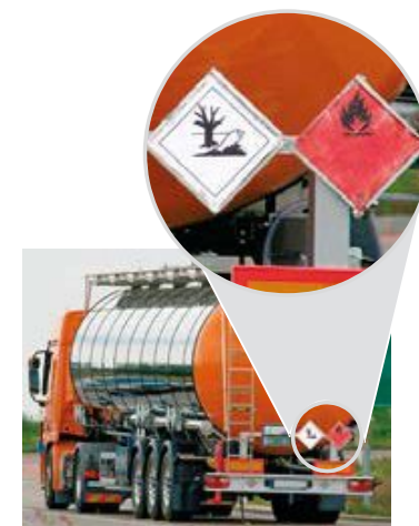
Fot. 4. Na samochodach przewożących substancje o niebezpiecznych właściwościach umieszcza się piktogramy.
