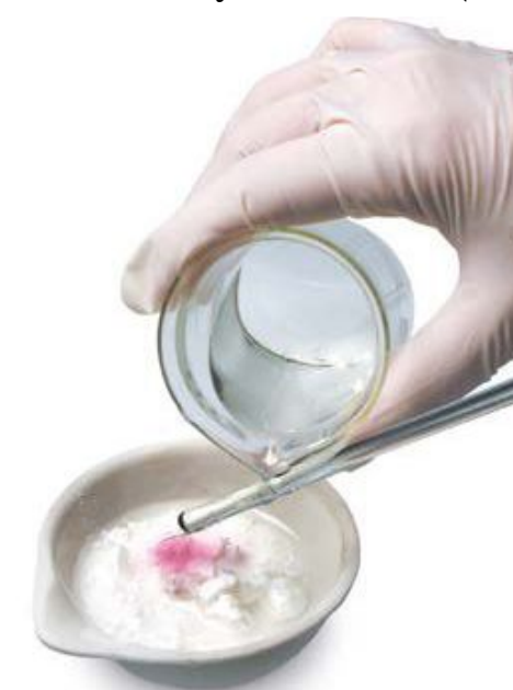
Fot. 72. Gaszenie wapna palonego.
