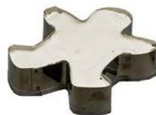
twardnienie zaprawy gipsowej
