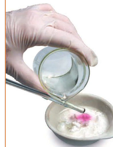
Fot. 60. Gaszenie wapna palonego.
