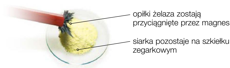
Fot. 13. Rozdzielanie mieszanki niejednorodnej – żelaza i siarki – na składniki za pomocą magnesu.
