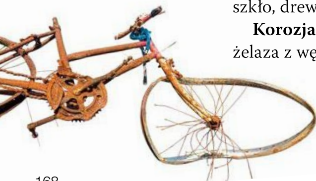
Fot. 54. Rdzewieją przedmioty wykonane z żelaza, żeliwa lub ze stali, np. rowery, szyny kolejowe, rury wodociągowe i karoserie samochodowe.
