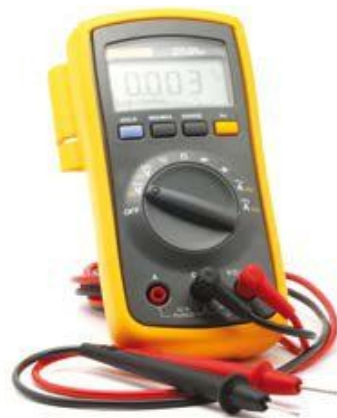
Fot. 52. Multimetr służy m.in. do pomiaru różnicy potencjałów.
