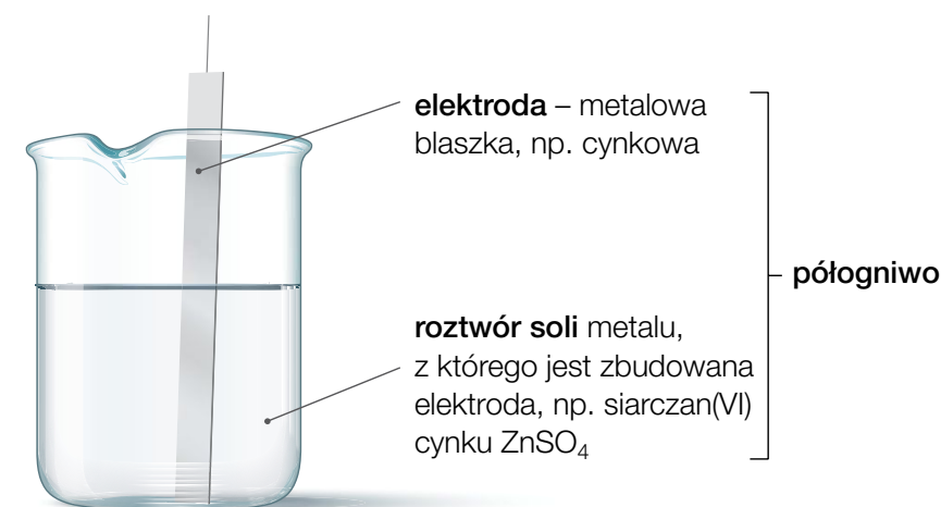
Rys. 26. Półogniwo cynkowe składa się z blaszki cynkowej zanurzonej w roztworze siarczanu(VI) cynku \text{ZnSO}_4 .
