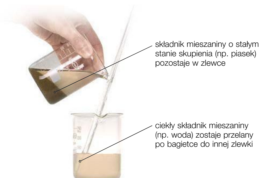
Fot. 14. Rozdzielanie mieszanki – wody i piasku – na składniki poprzez dekantację.
