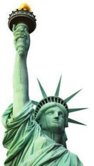
Fot. 121. Patynę, nazywaną również śniedzią, można usunąć, stosując roztwór \text{NH}_3 lub \text{NaCl} i \text{CH}_3\text{COOH} w ciepłej wodzie.
