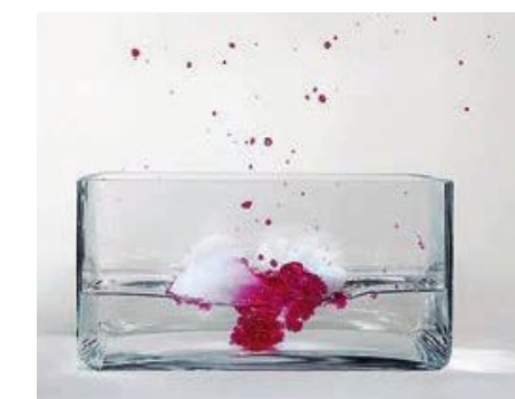
Fot. 72. Reakcja rubidu z wodą w obecności roztworu fenoloftaleiny.
