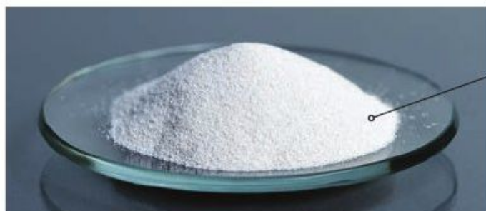
Fot. 81. Tlenek glinu \text{Al}_2\text{O}_3 ma charakter amfoteryczny.
