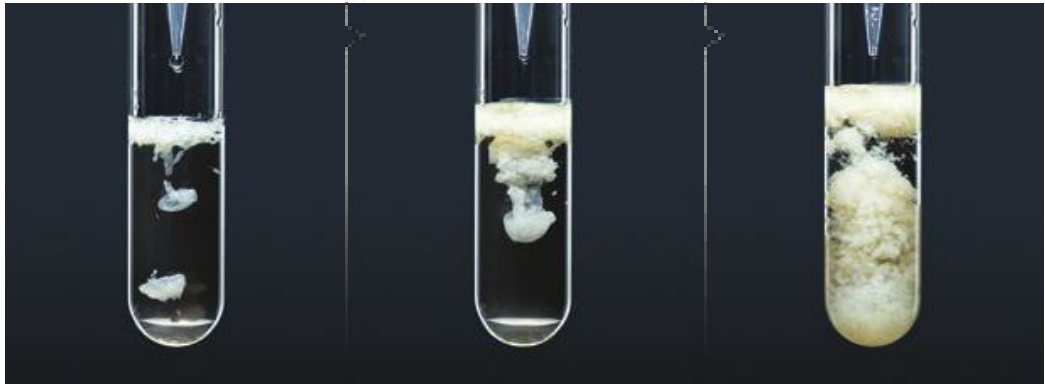
Fot. 114. Otrzymywanie wodorotlenku manganu(II) i badanie jego zachowania w czasie.
