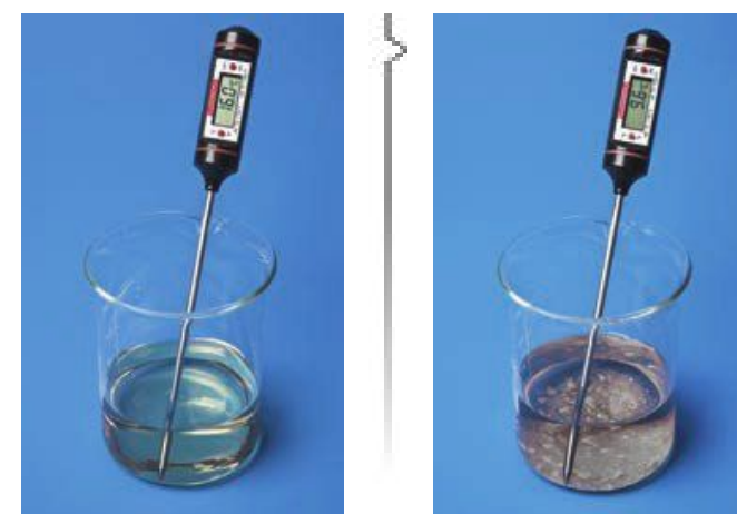
Fot. 24. Podczas reakcji kwasu octowego i wodorowęglanu sodu obniża się temperatura roztworu w zlewce.
