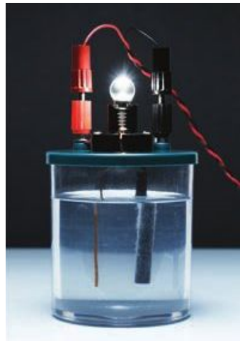
Fot. 12. Świecąca żarówka świadczy o tym, że roztwór przewodzi prąd elektryczny.
