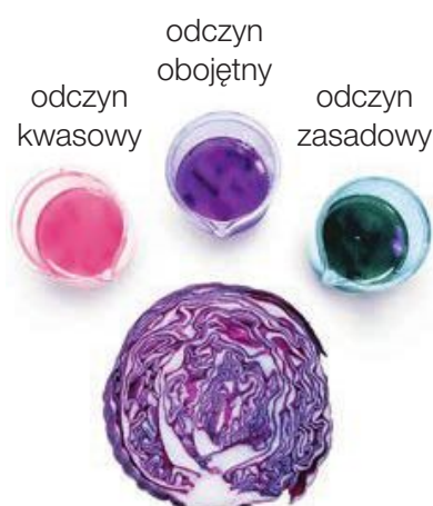
Fot. 54. Barwa soku z czerwonej kapusty, stosowanego w postaci roztworów wodnego lub alkoholowego, zmienia się w zależności od odczynu badanego roztworu.
