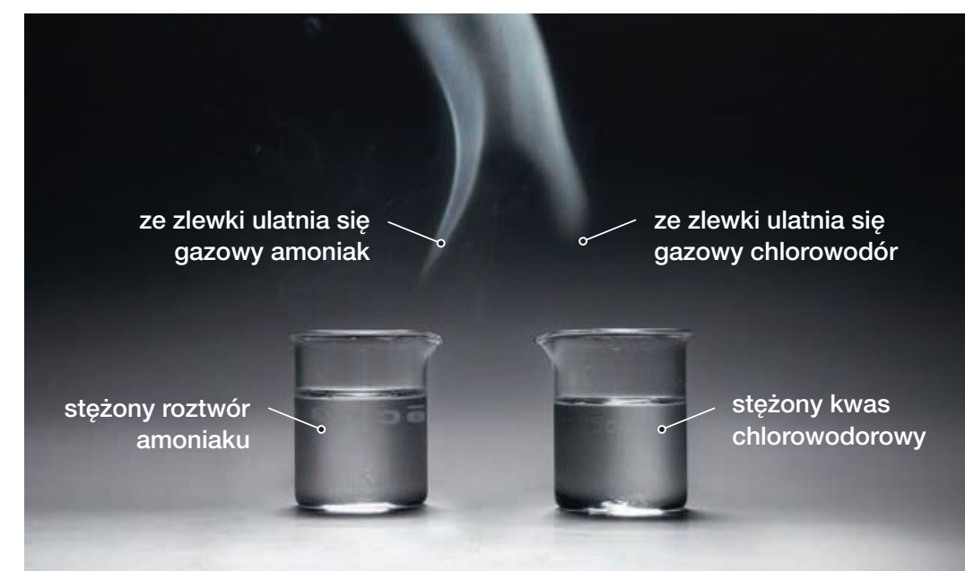
Fot. 87. Białą chmurę, która powstaje nad zlewkami z wodą amoniakalną oraz z kwasem chlorowodorowym, tworzą mikroskopijnej wielkości kryształki chlorku amonu NH_4Cl .
