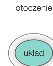
układ izolowany brak wymiany
