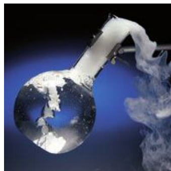
Fot. 33. Suchy lód wrzucony do wody zmienia stan skupienia ze stałego na gazowy – sublimuje. Jednocześnie zawartość kolby się ochładza.
