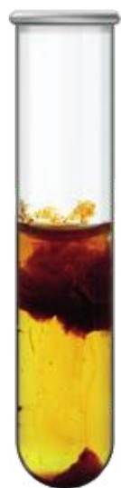
Fot. 66. Osad wodorotlenku żelaza(III).
