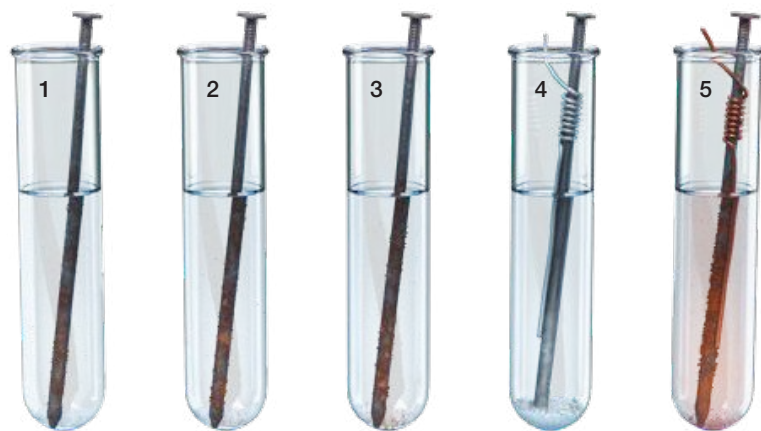
Fot. 17. Badanie wpływu różnych czynników na szybkość korozji elektrochemicznej.
