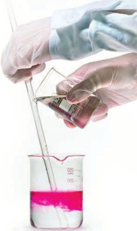
Fot. 64. Zobojętnianie roztworu \text{HNO}_3 roztworem \text{NaOH} w obecności roztworu fenolftaleiny.
