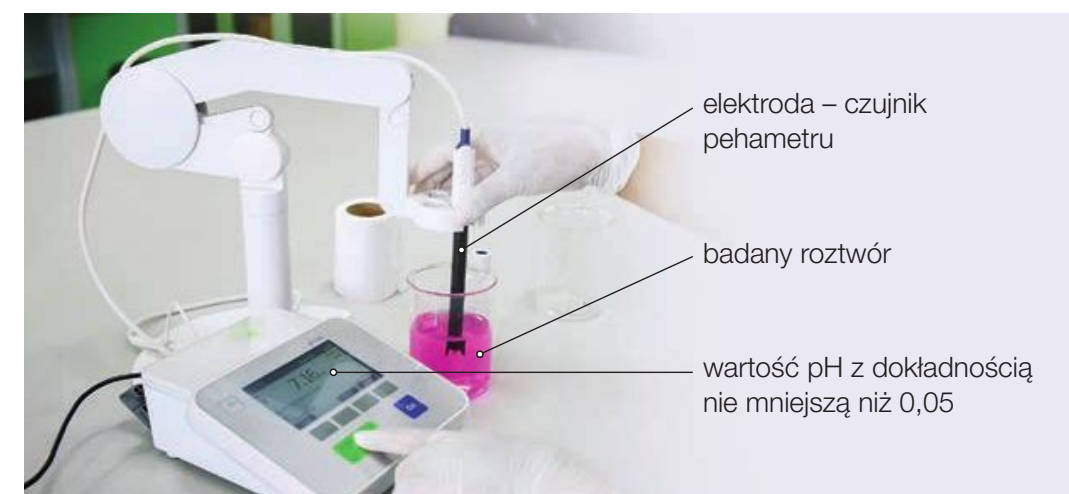
Fot. 53. Pehametry służą do wykonywania pomiarów pH.
