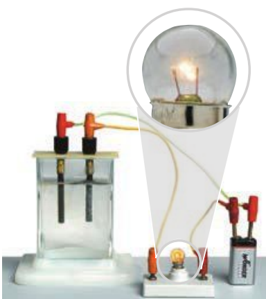
Fot. 44. Elektrolity przewodzą prąd elektryczny, o czym świadczy świecąca się żarówka.
