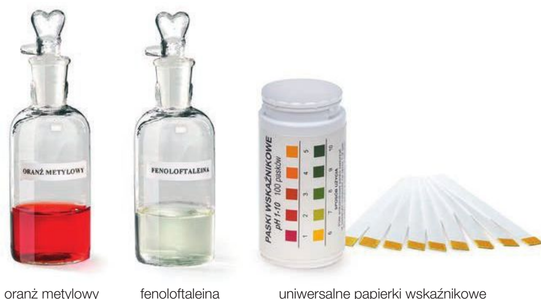
Fot. 45. Odczyn ustala się za pomocą roztworu wskaźnika lub pasków bibuły nasączonych takim roztworem.
