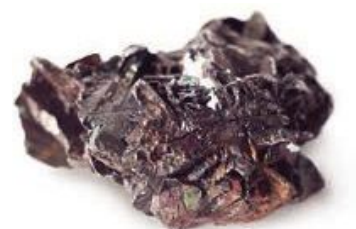
Fot. 4. Dzięki reakcji redoks można otrzymać np. cynk z jego rudy – blendy cynkowej , której głównym składnikiem jest siarczek cynku.
