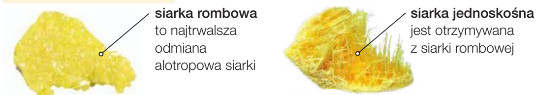
Fot. 95. Siarka rombowa jest trwała w temperaturze < 96^\circ\text{C} . W wyższej temperaturze przekształca się w siarkę jednoskośną. Jest to przemiana odwracalna.
