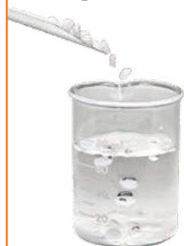
Fot. 26. Rozpuszczanie wodorotlenku sodu w wodzie.
