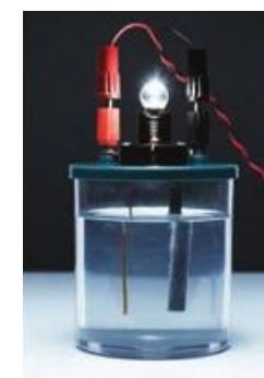
Fot. 46. Wodne roztwory kwasów, zasad i soli przewodzą prąd elektryczny.
