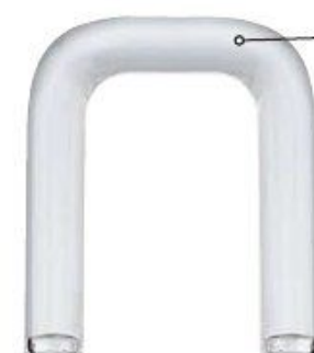
Fot. 14. Wygięta rurka zanurzona w roztworach elektrolitów wypełniona roztworem KCl to najczęściej stosowany klucz elektrolityczny.
