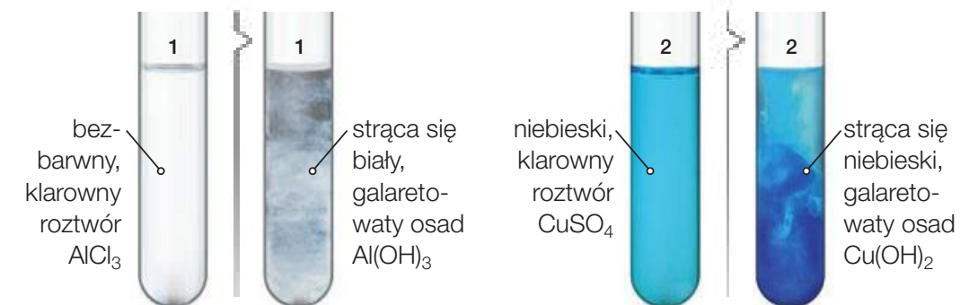
Fot. 67. Osady wodorotlenku glinu oraz wodorotlenku miedzi(II) powstają w reakcji zasad z odpowiednimi solami.
