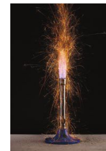
Fot. 31. Sproszkowane żelazo umieszczone w płomieniu palnika zapala się, a więc gwałtownie się utlenia. Ten efekt nie występuje podczas ogrzewania żelaznego pręta.
