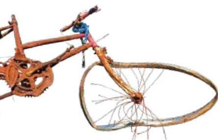
Fot. 29. Rdzewienie żelaza to reakcja chemiczna, która zachodzi z niewielką szybkością.
