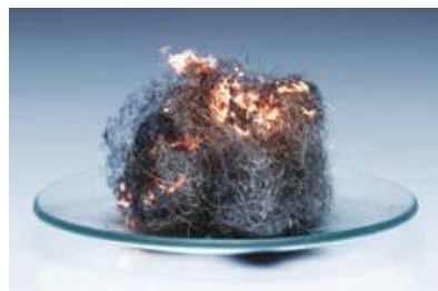
Fot. 1. Podczas spalania wełny stalowej powstaje mieszanina różnych tlenków żelaza.
