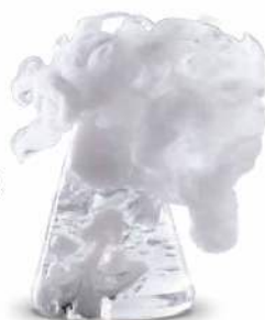
przykład układu otwartego – kolba z wodą, do której dodano suchy lód, czyli zestalony \text{CO}_2
