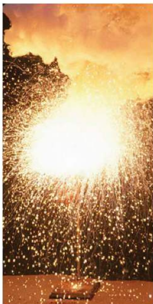
Fot. 148. W wyniku reakcji glinu z tlenkiem żelaza(III) oprócz tlenku glinu i żelaza powstaje także duża ilość energii.
