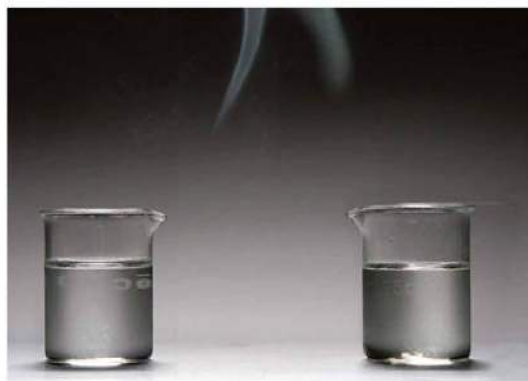
Fot. 154. Białą chmurę powstającą nad zlewkami z wodą amoniakalną oraz z roztworem kwasu chlorowodorowego tworzą mikroskopijnej wielkości kryształki chlorku amonu \text{NH}_4\text{Cl} (salmiaku).
