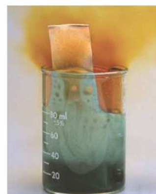
Fot. 184. Intensywnie wydzielający się ze zlewki gaz to trujący tlenek azotu(IV).
