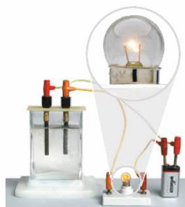
Fot. 119. Elektrolity przewodzą prąd elektryczny, o czym świadczy świecąca się żarówka.
