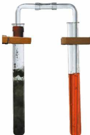
Fot. 41. Otrzymywanie kwasu siarkowodorowego.
