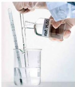
Fot. 101. Podczas mieszania się roztworu \text{H}_2\text{SO}_4 z wodą zachodzi zjawisko egzotermiczne – energia wydziela się na sposób ciepła.
