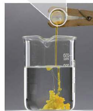
Fot. 161. Siarka plastyczna w zimnej wodzie natychmiast zastyga.
