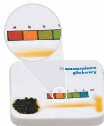
Fot. 131. Badanie odczynu gleby kwasomierzem Helliga.
