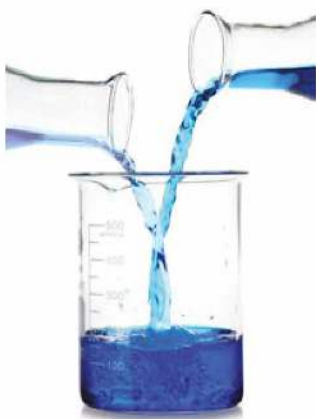
Fot. 96. Po zmieszaniu roztworów zmieniają się m_r , m_s i C_p .
