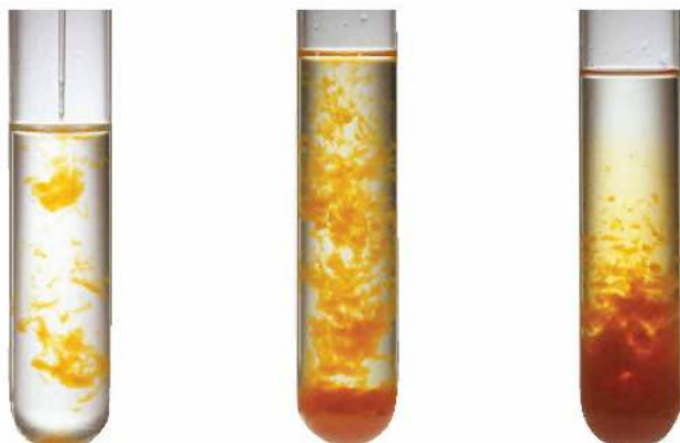
Fot. 36. Produkt reakcji chemicznej FeCl 3 z NaOH nie rozpuszcza się w wodzie.
