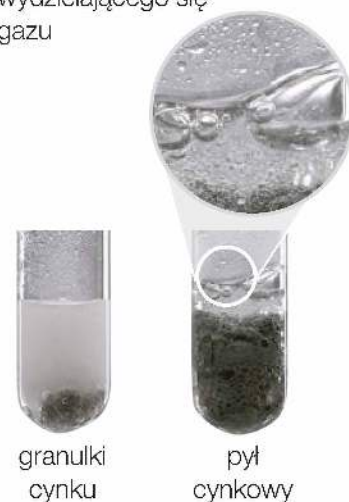
Fot. 110. Reakcja kwasu chlorowodorowego z cynkiem.
