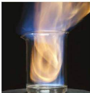
Fot. 1. Badanie właściwości etanolu – palność.
