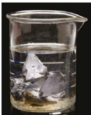
Fot. 141. Ze względu na dużą aktywność chemiczną sód należy przechowywać w nafcie, która chroni go przed dostępem powietrza i wilgoci.
