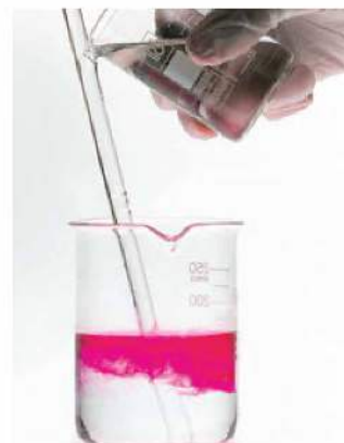
Fot. 133. Zobojętnianie roztworu NaOH roztworem HNO_3 w obecności roztworu fenoloftaleiny.
