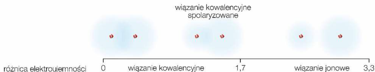
Rys. 26. Jeżeli różnica elektroujemności jest mniejsza od 1,7, to powstaje wiązanie kowalencyjne, jeżeli jest równa 1,7 lub większa – wiązanie jonowe.
