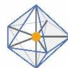
hybrydyzacja d^3sp^3 – kształt bipyramidy pentagonalnej
