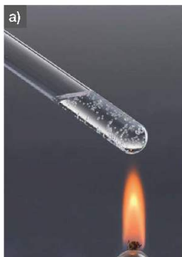
Fot. 90. W podwyższonej temperaturze z wody mineralnej wydzielą się gazy – \text{CO}_2 – a). Można go zidentyfikować za pomocą wody wapiennej, która pod jego wpływem mętnieje – b).
