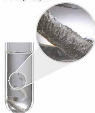
Fot. 147. Pasywacja glinu w kwasie azotowym(V).
