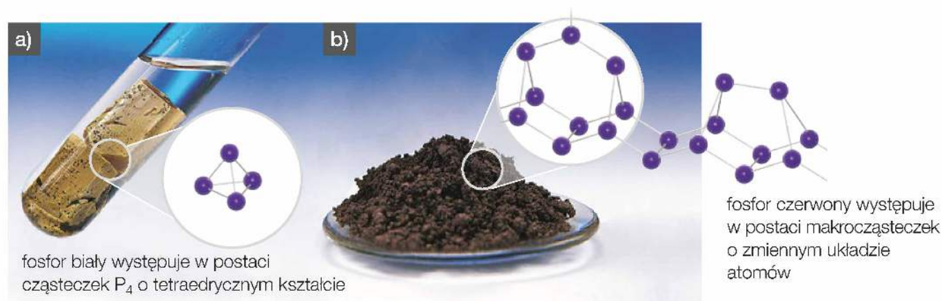
Fot. 152. Fosfor biały (a) i fosfor czerwony (b) różnią się wyglądem, budową wewnętrzną i właściwościami.
