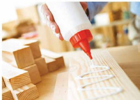
Fot. 16. Podczas klejenia drewna powstają wiązania wodorowe.
