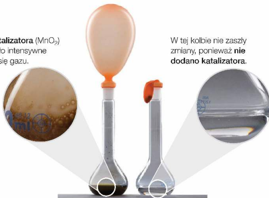
Fot. 115. Rozkład nadtlenku wodoru.
