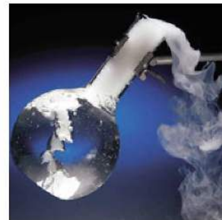
Fot. 109. Suchy lód wrzucony do wody zmienia stan skupienia ze stałego na gazowy – sublimuje. Jednocześnie zawartość kolby ochładza się.
