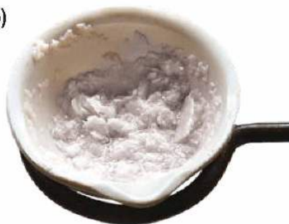
Fot. 97. Reakcja kwasu stearynowego z wodorotlenkiem sodu: a) ogrzewanie mieszaniny w parownicy, b) produkt reakcji chemicznej.
