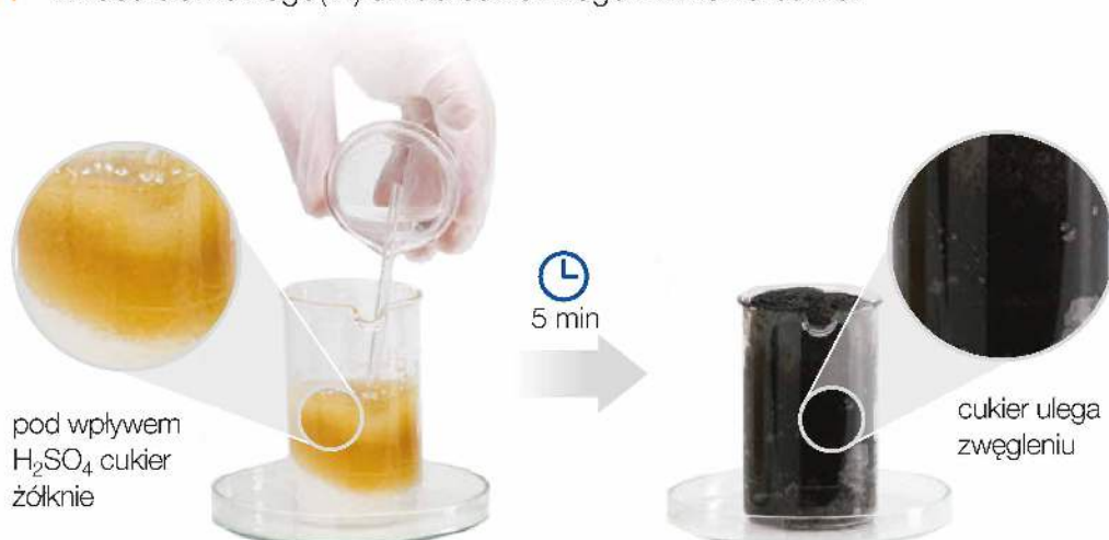
Fot. 159. Zachowanie cukru pod wpływem stężonego roztworu \text{H}_2\text{SO}_4 .
