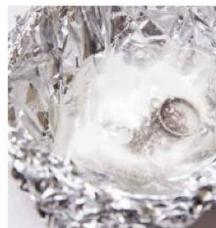
Fot. 104. Do czyszczenia srebra można wykorzystać metodę redukcji elektrochemicznej, która polega na umieszczeniu srebrnych przedmiotów w roztworze chlorku sodu w naczyniu wyłożonym folią aluminiową.
