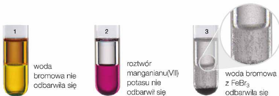
Fot. 31. Zachowanie benzeny wobec: wody bromowej, roztworu \text{KMnO}_4 , wody bromowej z \text{FeBr}_3 .
