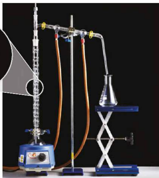
Fot. 43. Zestaw laboratoryjny do przeprowadzania rektyfikacji ropy naftowej.
