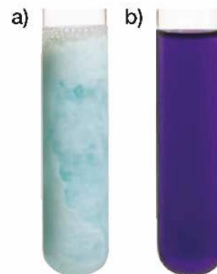
Fot. 155. Reakcja biuretowa: a) dodanie wodorotlenku miedzi(II) do białka; b) ciemnofioletowe zabarwienie roztworu.
