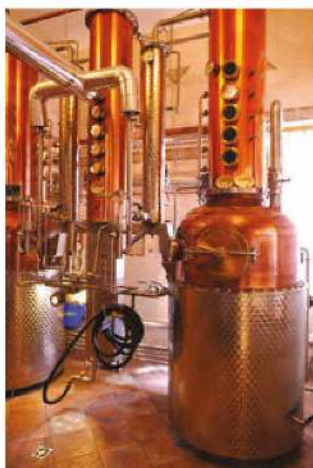
Fot. 57. Spirytus rektyfikowany otrzymuje się w specjalnych kolumnach rektyfikacyjnych wykonanych z miedzi lub ze stali szlachetnej.
