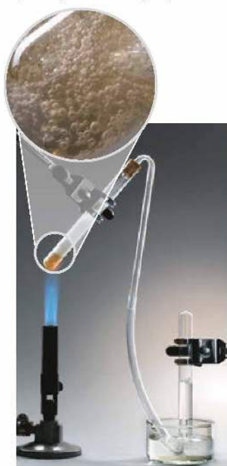
Fot. 22. Otrzymywanie etenu z folii polietylenowej.
