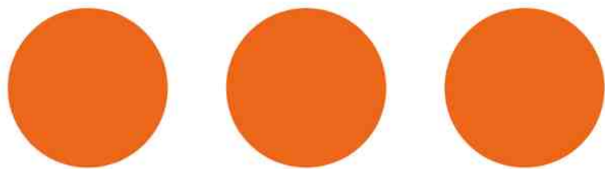
Międzynarodowy znak specjalny dla budowli i urządzeń zawierających niebezpieczne siły
