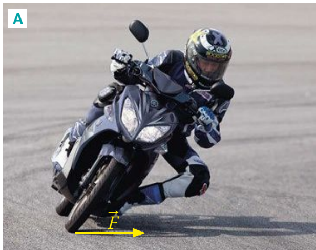
▲ Siły wpływające na zmianę kierunku ruchu ciała: A. siła tarcia działająca na motocykl na zakręcie, B. siła naprężenia liny działająca na kulę
