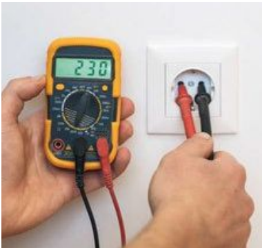
▲ Z miernika włączonego jako woltomierz napięcia przemiennego (ACV) odczytujemy napięcie skuteczne
