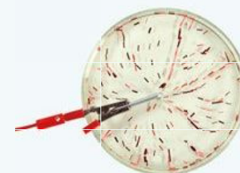
▲ Linie pola wytworzonego przez pojedynczy ładunek
