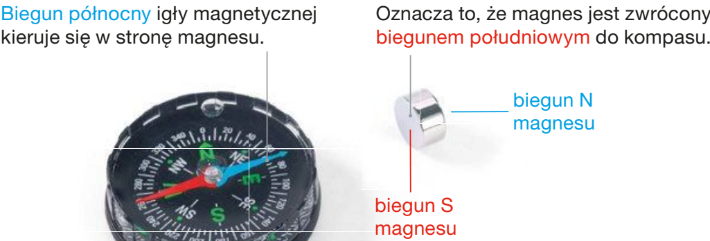
▲ Magnes przyciągnął biegun północny igły magnetycznej, więc widocznie jest do niej zwrócony biegunem południowym
