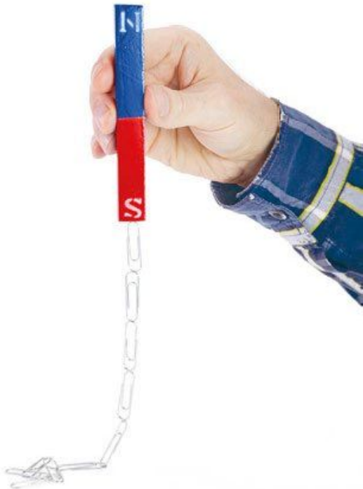
▲ Stalowy spinacz przyczepiony do magnesu sam staje się magnesem i przyciąga kolejne spinacze
