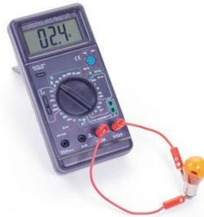
▲ Sprawdzanie żarówki za pomocą omomierza
