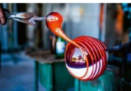
Rys. 7.15. Podgrzewane szkło robi się miękkie, a nie od razu topnieje, więc można formować z niego różne kształty
