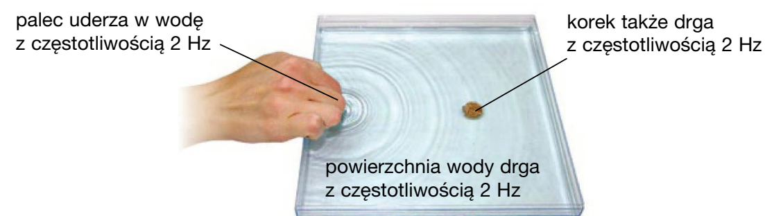
Rys. 11.11. Drgania źródła fal, ośrodka i ciała poruszanego przez falę mają jednakową częstotliwość
