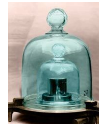
Rys. 1.12. Oryginał wzorca kilograma, który obowiązywał do 2019 roku
