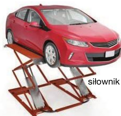
Rys. 6.9. Podnośnik hydrauliczny pozwala podnieść samochód w warsztacie
