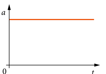
Rys. 2.20. Wykres zależności przyspieszenia od czasu w ruchu jednostajnie zmiennym
