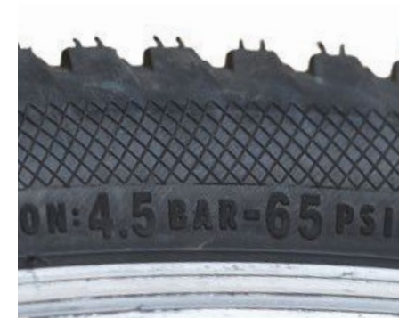
Rys. 6.25. Informacja o zalecanej wartości ciśnienia na oponie roweru
