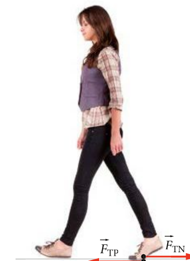
Rys. 4.17. Dzięki sile tarcia statycznego F_{TN} działającej na nogę jest możliwy ruch człowieka. Łatwo zaobserwować skutki braku siły tarcia, gdy próbujemy chodzić po lodzie
