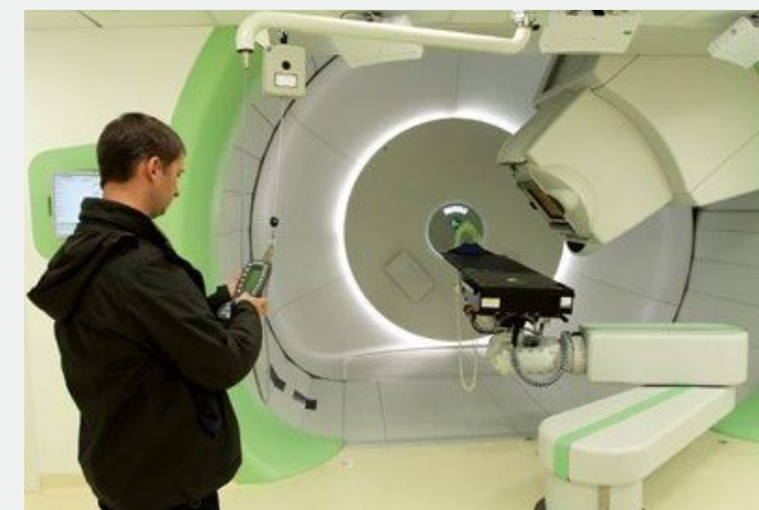
Stanowisko do naświetlania wiązką protonową wytworzoną przez cyklotron (Kraków-Bronowice)
