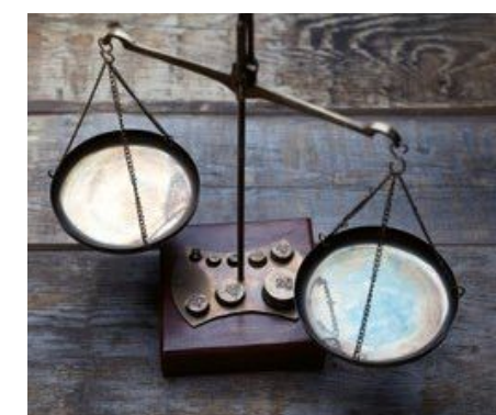
Rys. 1.8. Na wadze szalkowej masę ważonego ciała porównujemy z masą wzorca – odważnika
