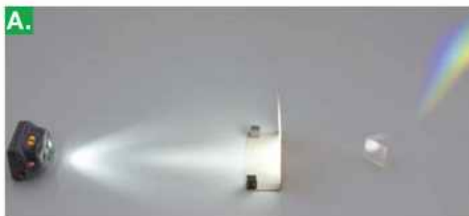
▲ Widmo światła białego po przejściu przez: pryzmat (A) i siatkę dyfrakcyjną (B)
