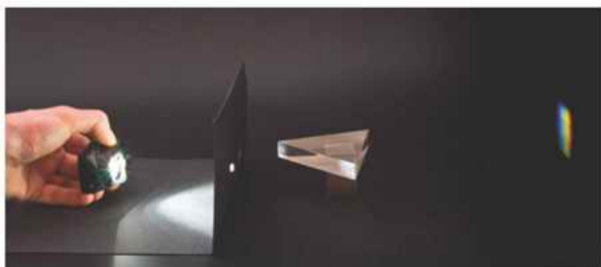
▲ Rozszczepienie światła za pomocą pryzmatu – układ doświadczalny i schemat zjawiska
