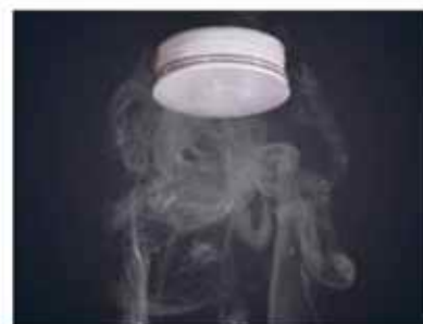
▲ Czujnik dymu wykorzystujący izotop promieniotwórczy
