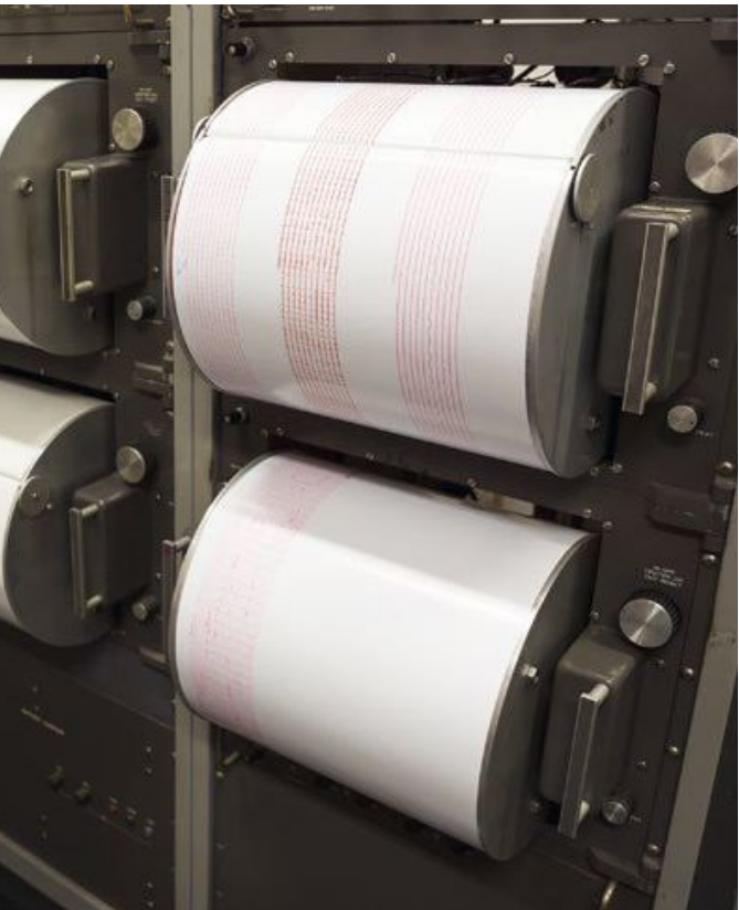
Urządzeniami służącymi do rejestrowania trzęsień ziemi są sejsmografy.
