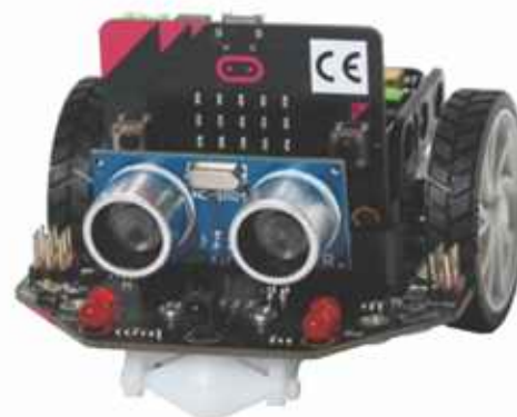
Rys. 11.7. Przykład robota micro:Maqueen, wykonanego z użyciem mikrokontrolera micro:bit
