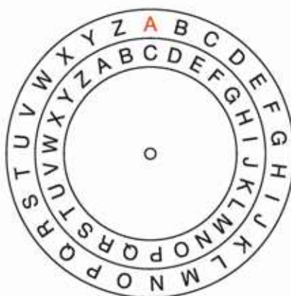
Rys. 2.7. Szyfrowanie liter szyfrem Cezara za pomocą obracających się tarcz
