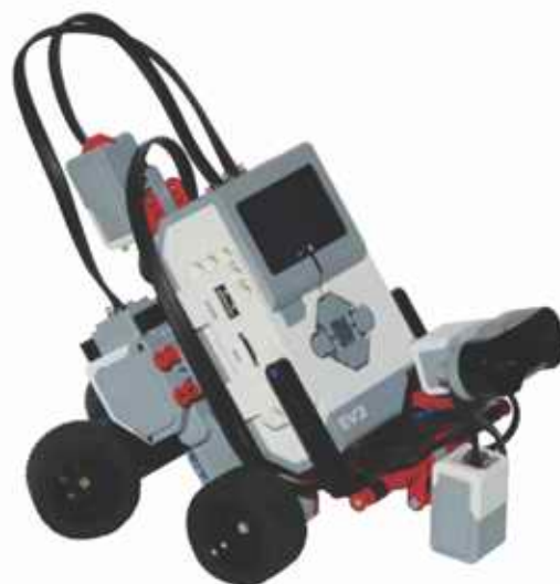
Rys. 11.3. Kostka EV3 wraz z podłączonymi do niej silnikami i czujnikami
